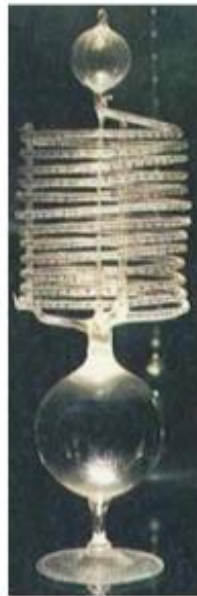
Ilustración 2. Termómetro de Florencia (Picquart & Carrasco Morales, 2017)
