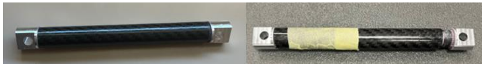
Imagen 13 Barra de suspensión antes (izquierda) y después (derecha) de ser ensayada
