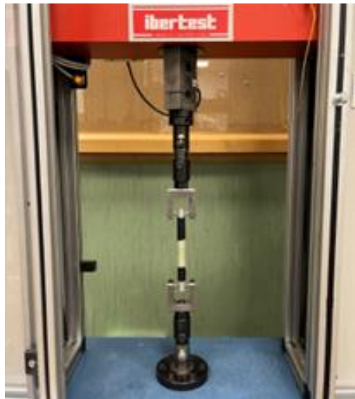
Imagen 7 Ensayo de tracción realizado
