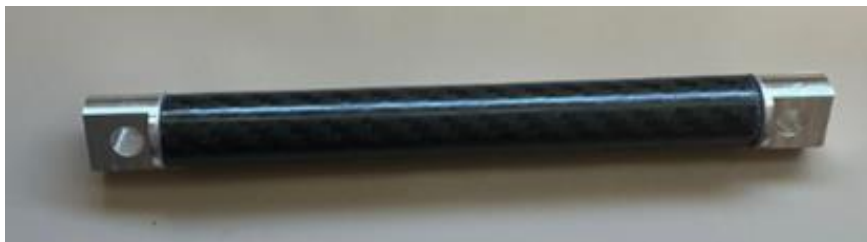
Imagen 6 Barra de suspensión ensayada
