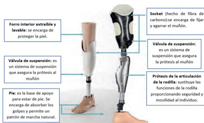
Figura 4. Componentes de una prótesis. Elaboración propia
