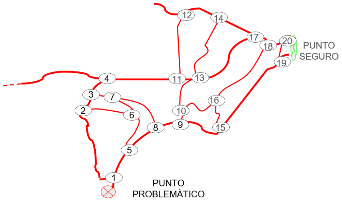
Figura 32. Carreteras a tratar como Red Vial principal con los distintos nodos y el punto problemático (nodo 1) y el punto seguro (nodos 19 y 20) definidos. 95
