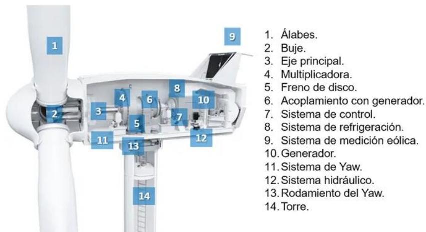
*Figura 7. Partes de un aerogenerador. Fuente: edp*
