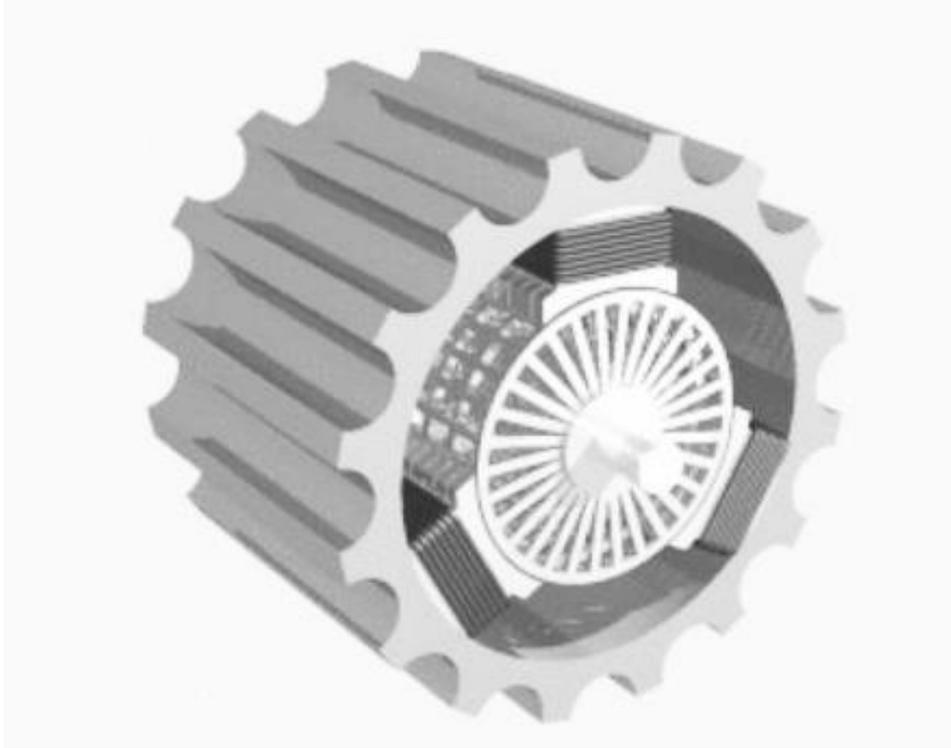
*Imagen 3. Representación esquemática del motor jaula de ardilla*
