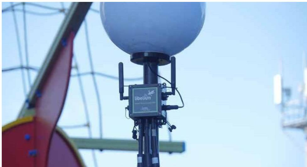
*Ilustración 3: Sensor de Calidad del Aire de Libelium [10].*
