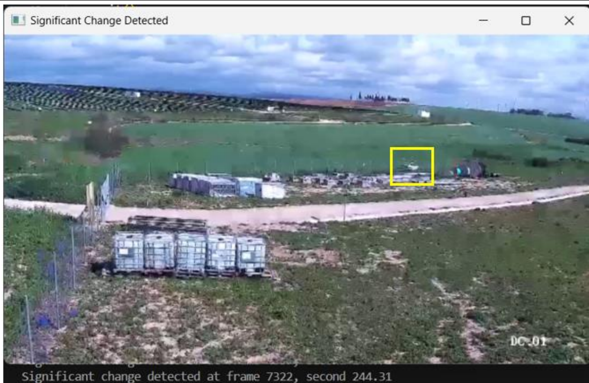
ILUSTRACIÓN 11. EJEMPLO DE DETECCIÓN DE UN SUCESO EN EL PROGRAMA DE PRUEBA (FRANCIA, 2024)
