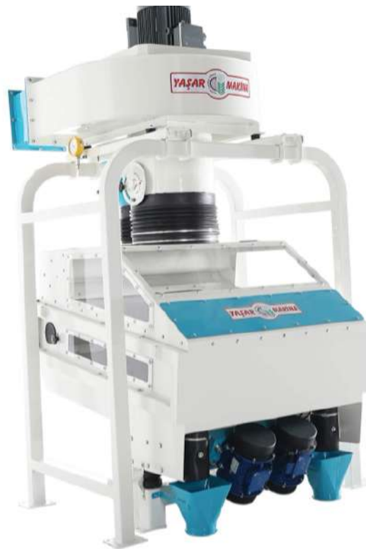
Figura 47. Máquina deschinadora marca Yasar modelo CPTA-5. Fuente: Suncue Company LTD. (2024).
