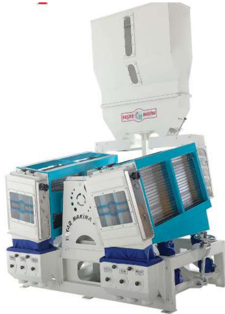
Figura 44. Maquina mesa paddy marca Yasar modelo PVB-4. Fuente: Suncue Company LTD. (2024).
