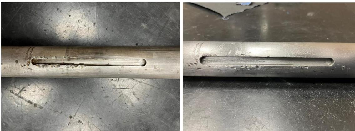
*Figura 63. Chavetero con defectos vs chavetero tras fresado*
