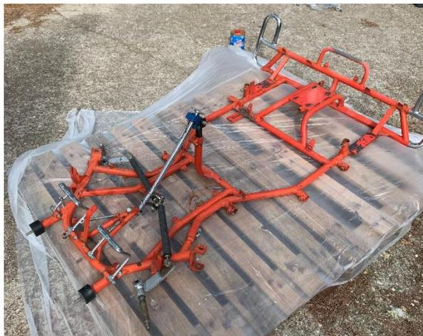
*Figura 29. Bastidor limpio y repintado*
