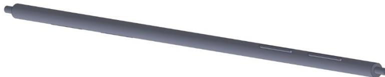
*Figura 39. CAD Eje con chavetas*
