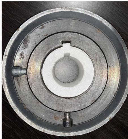
*Figura 57. Ajuste del prototipo en polea dentada*
