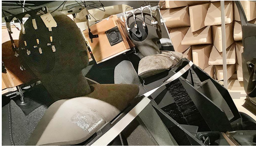
Ilustración 10 Micrófonos colocados en un coche de prueba -Universidad de Le Mans (Romero, El algoritmo que ayudará a viajar en coche con niños: burbujas de sonido delimitadas a cada asiento, 2022)
