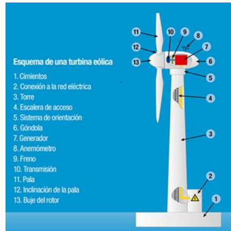
Figura 8. Partes de un aerogenerador [24]
