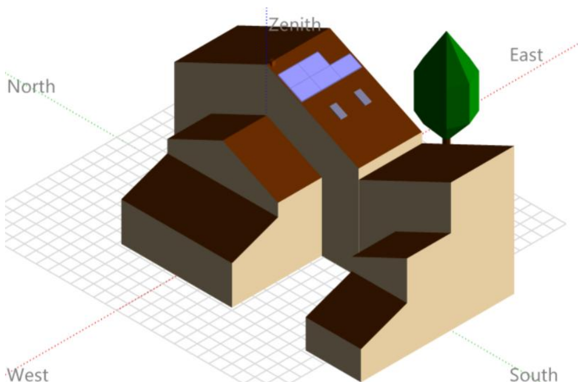
Ilustración 11: Representación gráfica de la vivienda y disposición de módulos solares. Elaboración propia en PVsyst.
