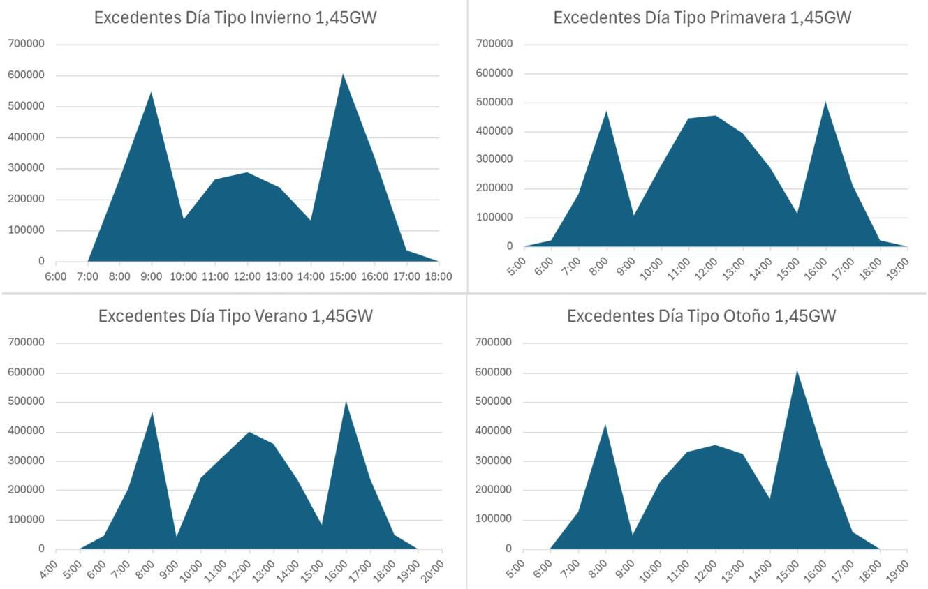
Figura A2.2: Excedentes fotovoltaicos por estación y hora, planta de 1,45GW
