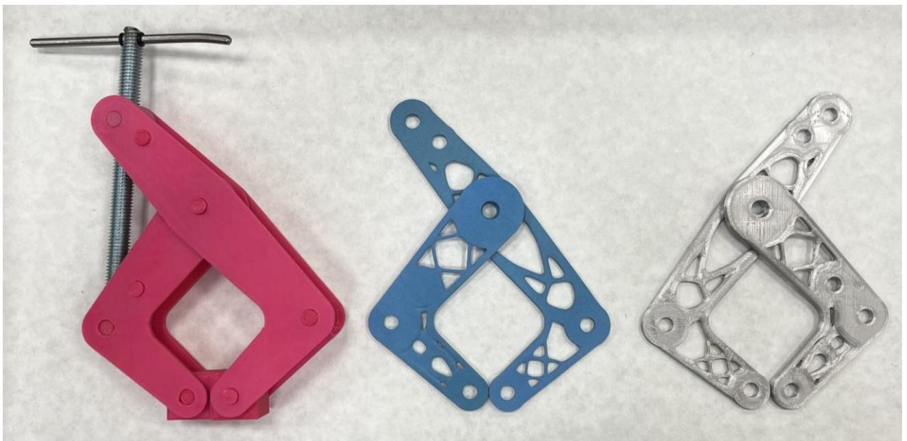
*Ilustración 86: Prototipos sin optimizar, impreso en polvo, impreso en PLA*
