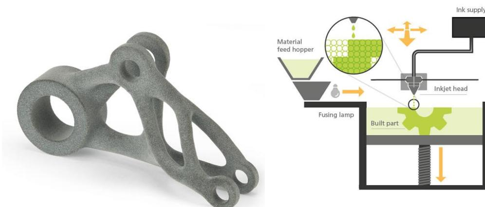
*Ilustración 21: Fabricación en polvo mediante MJF*
