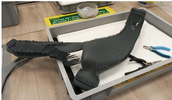
Figura 123. Eliminación de los soportes de la pieza. (Elaboración propia)
