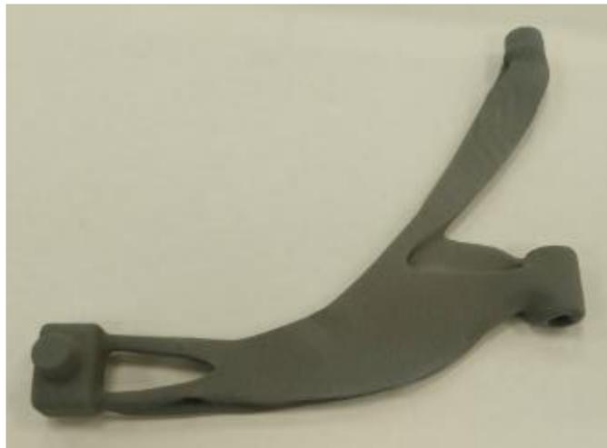
Figura 156. Pieza impresa por MJF en escala reducida. (Cortesía de Mariano Jiménez Calzado)
