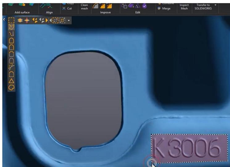
Figura 36. Limpieza de la superficie del soporte del brazo. (Elaboración propia)
