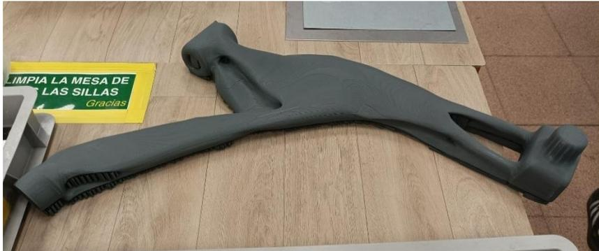
Figura 155. Brazo de suspensión impreso por FDM. (Elaboración propia)
