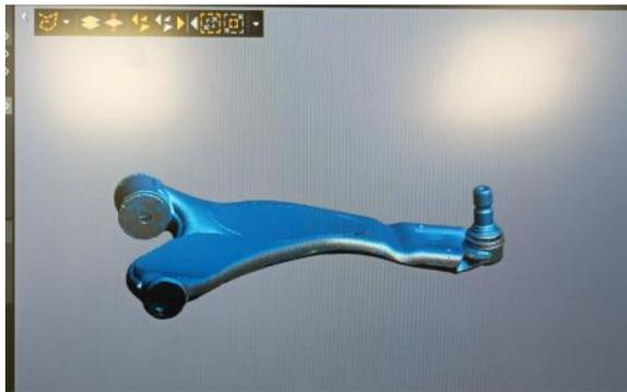
Figura 37. Mallas fusionadas del brazo de suspensión. (Elaboración propia)
