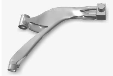
*Figura 13. Modificación geométrica del Brazo de Suspensión según criterios de diseño. (Elaboración propia)*
