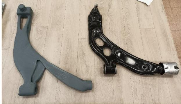
*Figura 15. Prototipo impreso por tecnología FDM, comparado con la pieza original. (Elaboración propia)*
