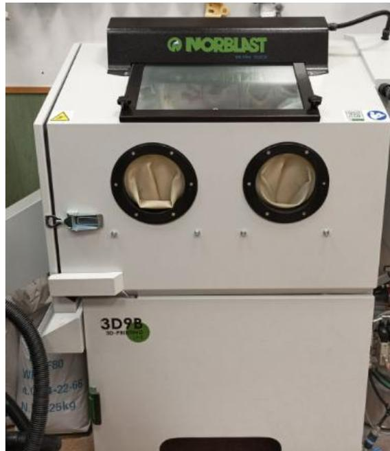
*Figura 127. Máquina NORBLAST para post-procesado de piezas impresas con la HP 580C.
