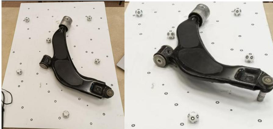
*Figura 28. Disposición del brazo de suspensión y las referencias. (Elaboración propia)*
