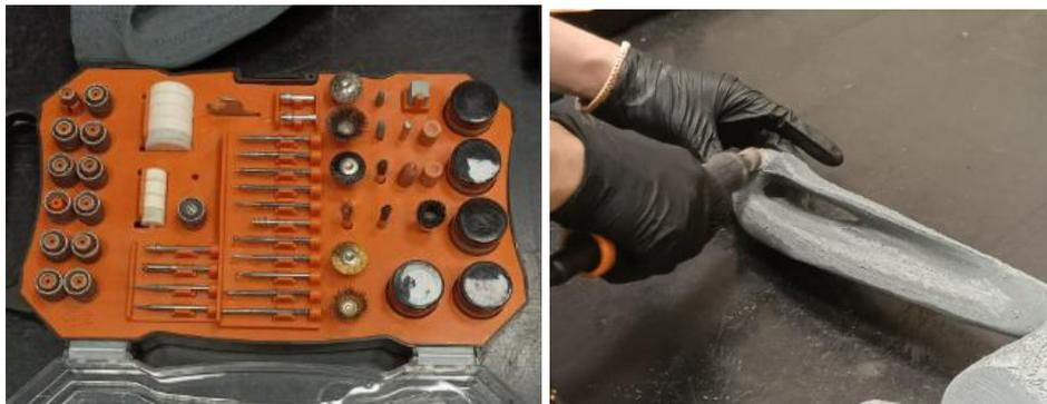
*Figura 125. Lijadora Dremel para eliminar rugosidades superficiales. (Elaboración propia)*
