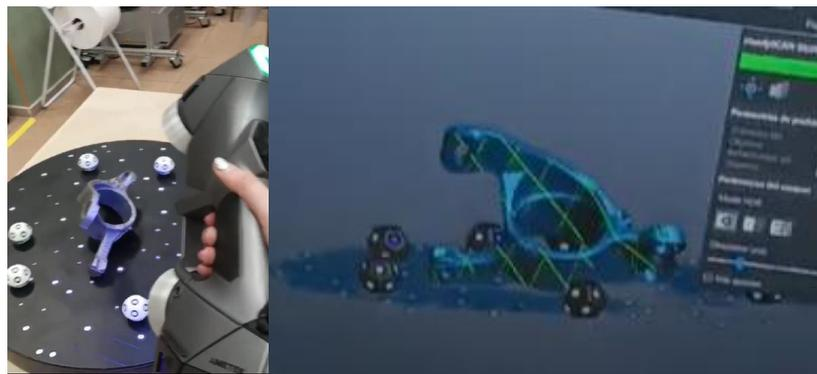
Figura 09. Barrido de la pieza con escáner. (Elaboración propia)
