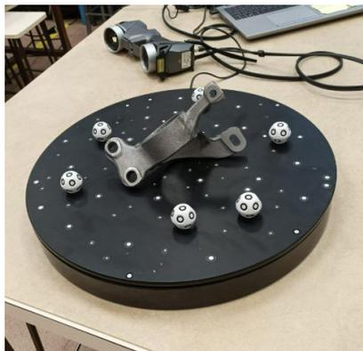
Figura 07. Preparación previa de la pieza para escanear. (Elaboración propia)
