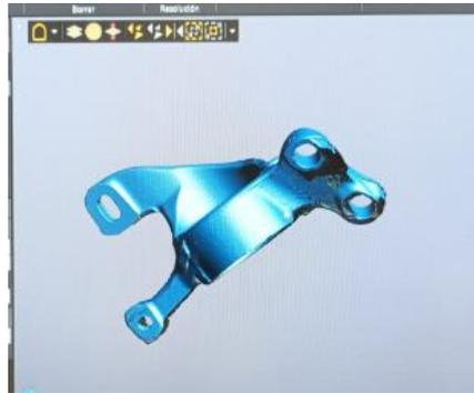
*Figura 10. Malla resultante de un escáner. (Elaboración propia)*
