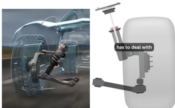
Figura 19. Brazo de suspensión tipo MacPherson. (MacPherson-vs-double-suspension, s. f.)
