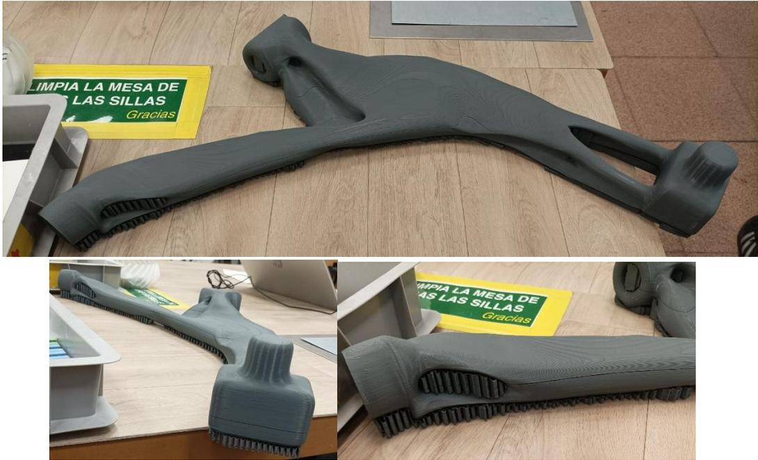
Figura 122. Pieza impresa por FDM sin post-procesar. (Elaboración propia)
