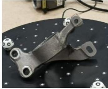
Figura 25. Soporte de brazos de suspensión de BMW X1 SDRIVA, 100kW. (Elaboración propia)
