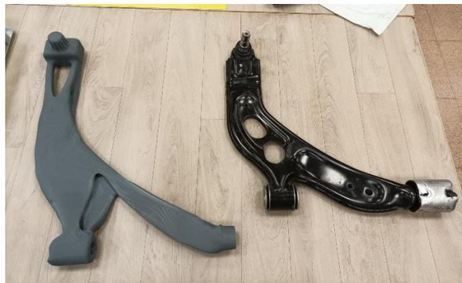
*Figura 158. Comparación entre la pieza original y la desarrollada en el proyecto. (Elaboración propia)*
