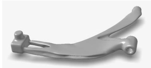
*Figura 14. Modelo refinado del Brazo de Suspensión. (Elaboración propia)*
