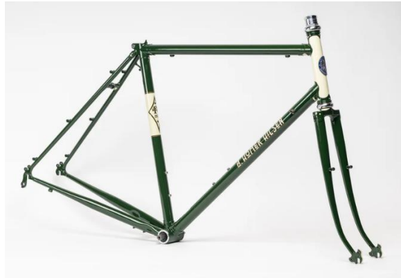
Ilustración 18. Cuadro de bicicleta Rivendell actual fabricada con racor metálico [27]
