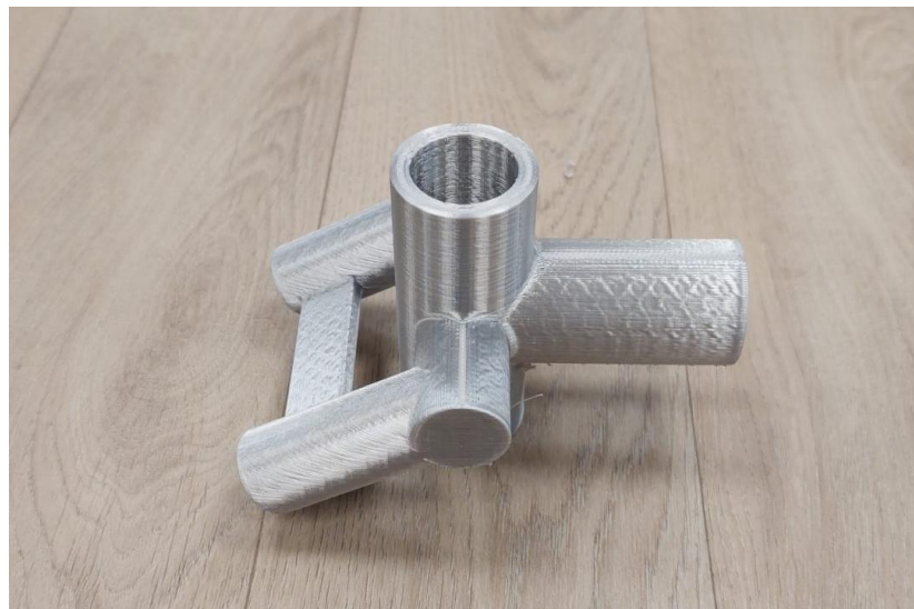
Ilustración 90. Pieza tras haberle retirado los soportes con unas pinzas
