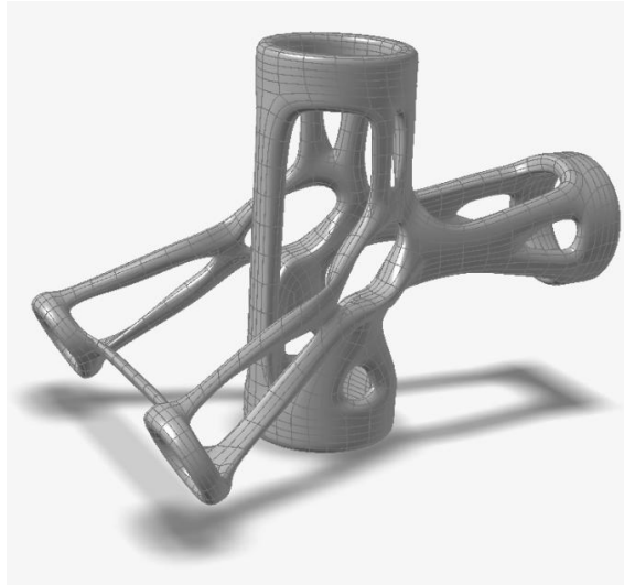
Ilustración 88. Pieza compuesta con refuerzo optimizada y refinada
