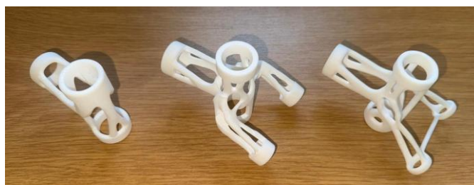
Ilustración 95. Piezas macizas impresas mediante SLA
