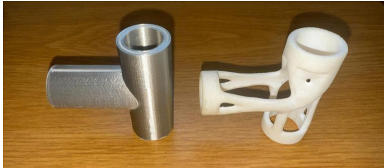
Ilustración 97 Comparativa entre la versión optimizada y la maciza sin optimizar de la pieza simple
