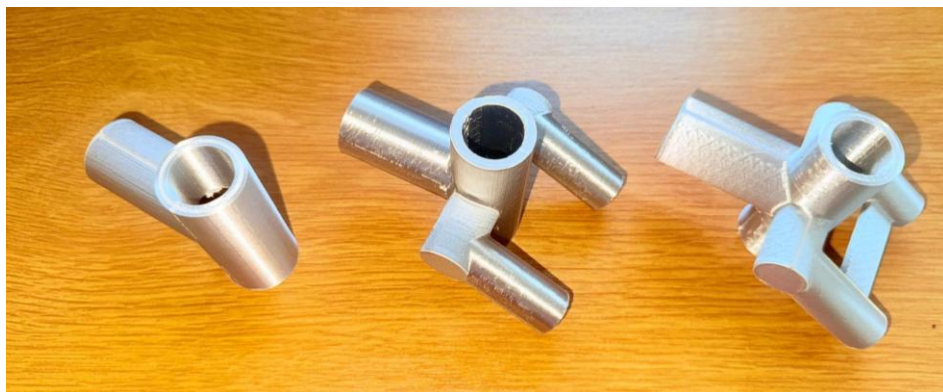
Ilustración 91. Piezas macizas impresas mediante FDM
