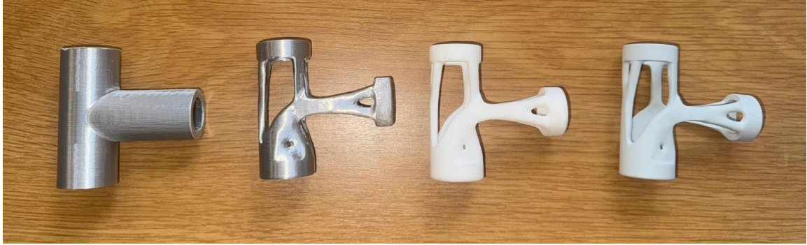
Ilustración 2. Comparativa visual entre la pieza maciza mediante FDM y las piezas refinadas mediante FDM, SLA y MJF.
