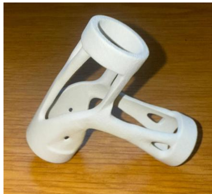
Ilustración 96. Pieza simple refinada impresa mediante MJF
