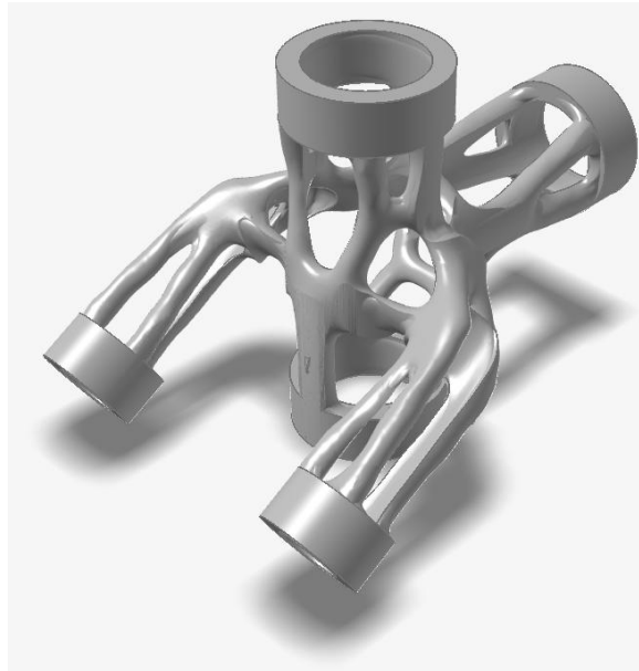
Ilustración 72. Pieza compuesta optimizada y refinada
