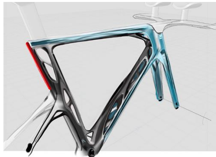
Ilustración 20. Bicicleta diseñada por Decathlon usando diseño generativo de Autodesk [33]
