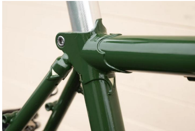
Ilustración 19. Detalle del racor del sillín del cuadro de la imagen superior [27]
