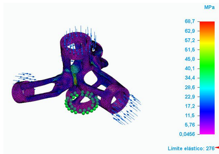
Ilustración 68. Simulación FEM de la reducción de masa del 57% de la pieza compuesta
