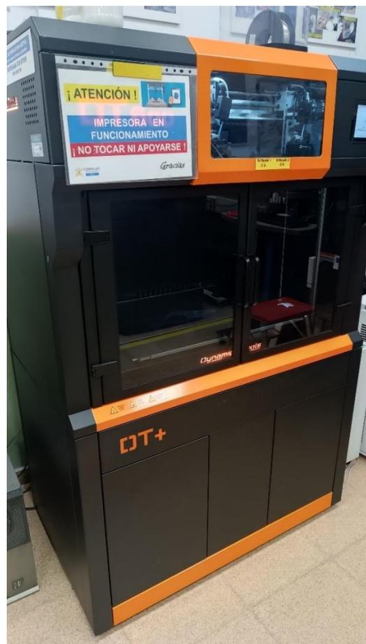
*Imagen 14: Impresora DT 600 de tecnología de filamentos FDM
