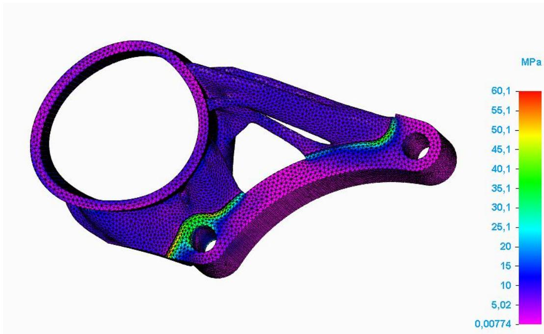
*Figura 45: Resultado de la simulación de las cargas sobre el diseño generativo 2.3. La tensión máxima es de 60,1 MPa.*
