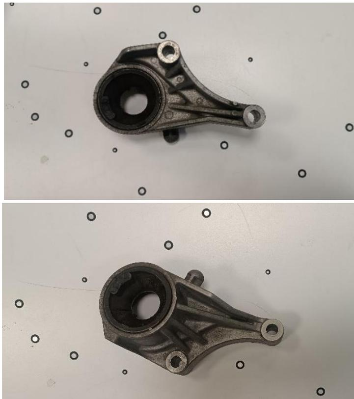
*Imagen 9: Preparación del Escaneo 3D con base llena de pegatinas de posición.
