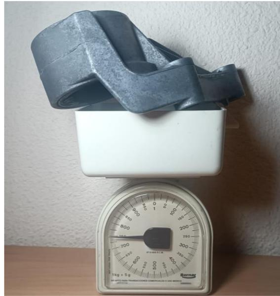
*Imagen 10: Medida de la masa del soporte, incluyendo amortiguador de caucho.
