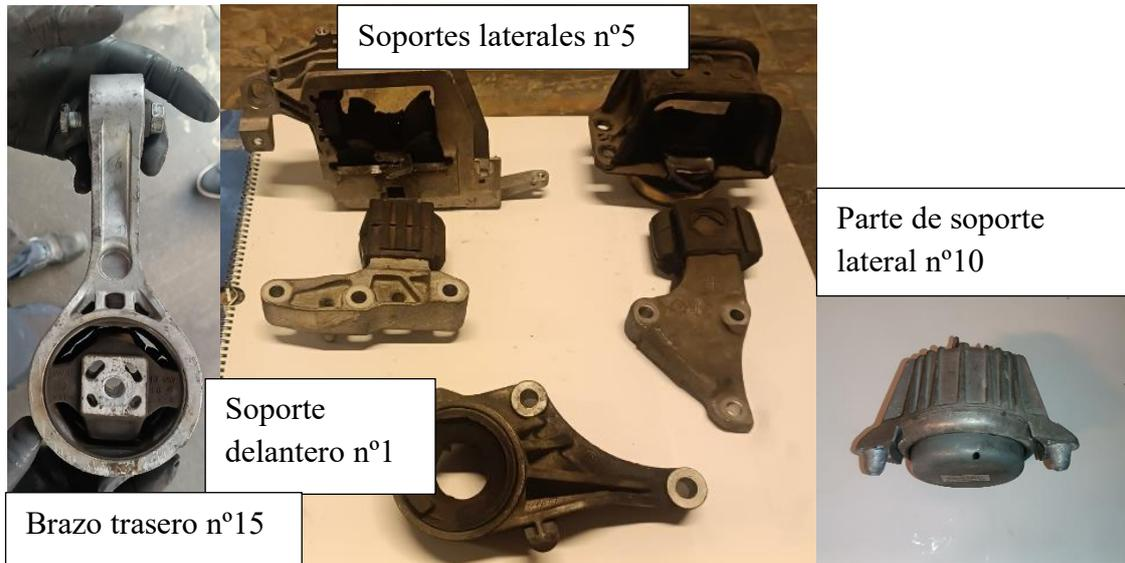
*Imagen 4: Soportes de motor y su denominación según el plano de la Figura 12.
