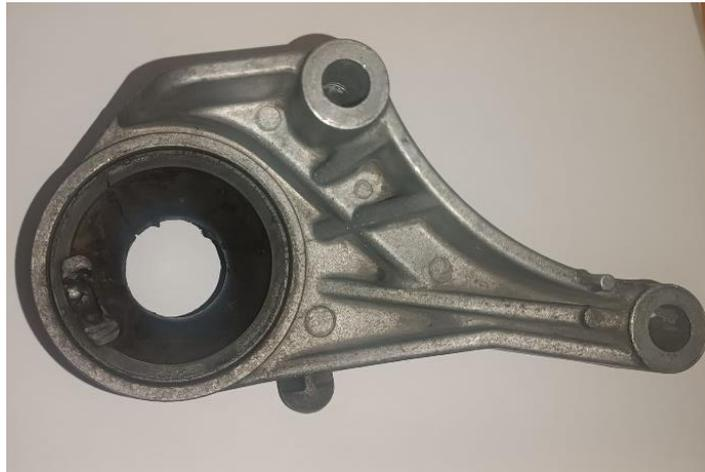
*Imagen 17: Soporte delantero del motor en su geometría original
