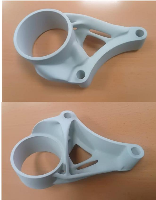
*Imagen 15: Resultado de la impresión por polvo en HP Jet Fusion.
