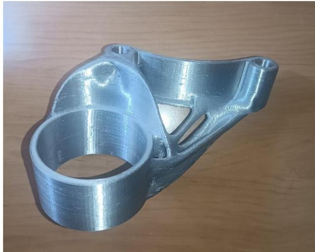
*Imagen 13: Resultado de la impresión FDM tras postprocesado.
