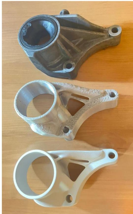
*Imagen 18: Vista de la pieza original fundida (arriba), y los dos prototipos plásticos impresos por FDM (centro) y polvo (abajo).
