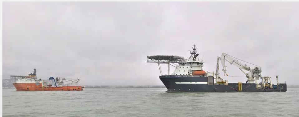
Ilustración 18. Ejemplo de barcos para el tendido de cables
