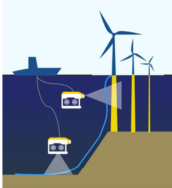
Ilustración 21. Inspección de cables en el fondo marino
