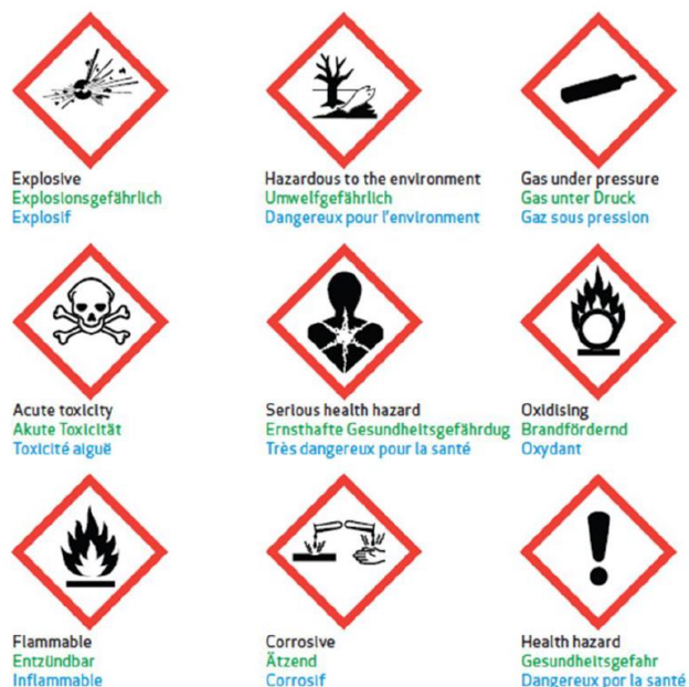
Ilustración 31. Símbolos de seguridad para almacenaje
