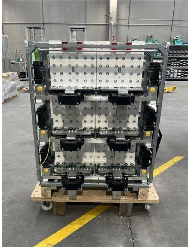
*Figura 23. Uno de los dos convertidores del nXL en proceso de fabricación [7].*
