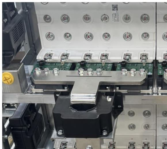
*Figura 22. Fase de uno de los Power Stack donde se aprecian los tres módulos [7].*
