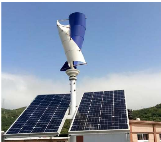
Figura 13: Aerogenerador de Eje Vertical
