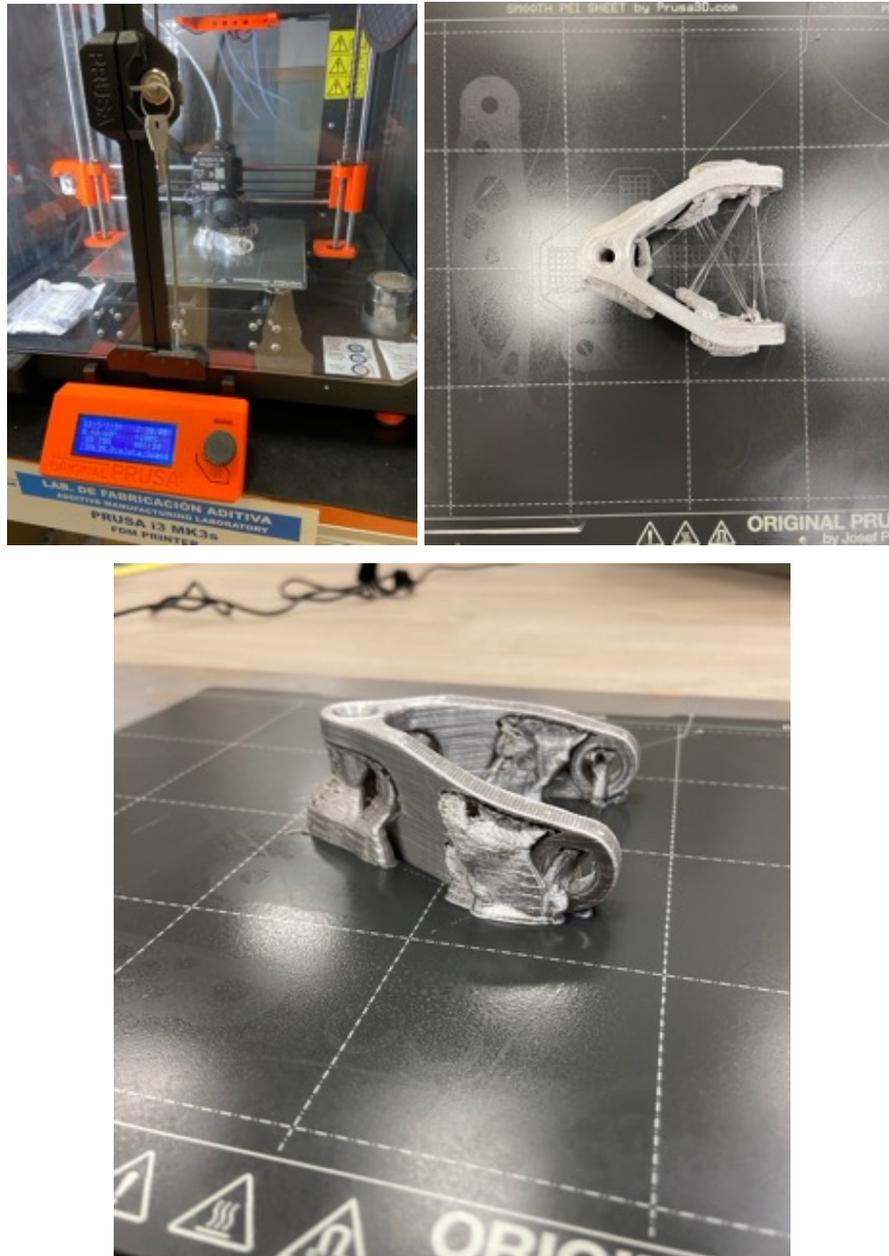
*Ilustración 127 Resultados impresión Prototipo N°2 en FDM, por la Prusa I3 MK3 (Fuente: Elaboración propia).*
