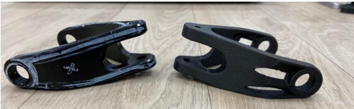
*Ilustración 133 Comparativa entre la bieleta original y el prototipo N°2 (Fuente: Elaboración propia).*
