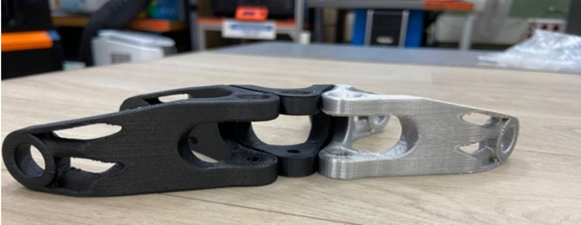
*Ilustración 134 Resultados de las impresiones por FDM (Fuente: Elaboración propia).*
