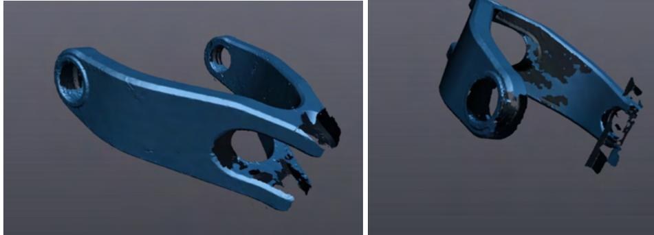
*Ilustración 55 Modelos digitales obtenidos del escaneo (Fuente: Elaboración propia).*
