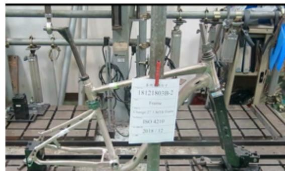
Ilustración 44 Estado de Cargas N°1, Norma UNE EN ISO 4210, 4.5, parte 6 (Fuente: UNE-EN-ISO).
