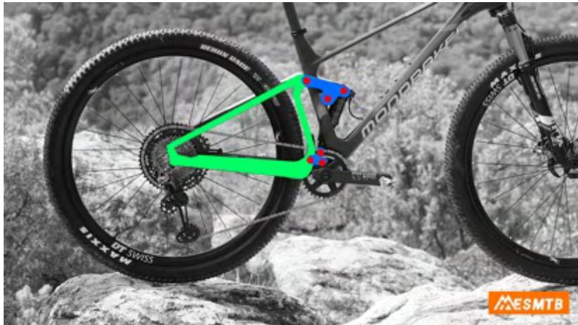
*Ilustración 33 Sistema Pivote Virtual (Fuente: ESMTB ).*
