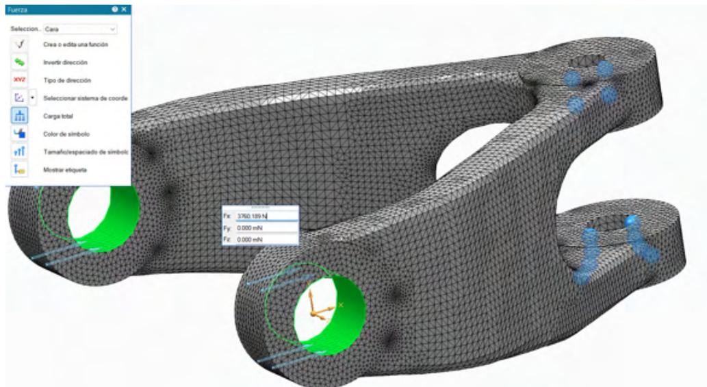
*Ilustración 70 Condiciones de contorno aplicadas a la bieleta en Al 6061, según el estado de cargas N°3*
