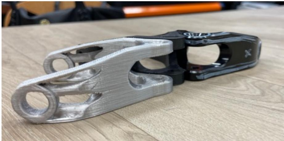
*Ilustración 129 Comparativa entre la bieleta original, la bruta y la optimizada (Fuente: Elaboración propia).*
