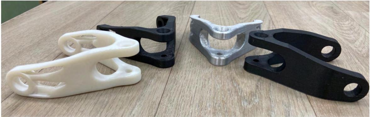
*Ilustración 2 Bieleta Optimizada Topológicamente al 21% de masa (Fuente: Elaboración propia).*
