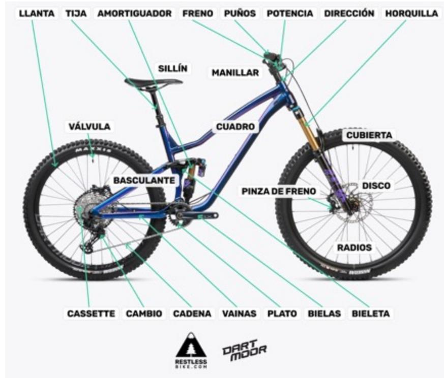
Ilustración 23 Componentes MTB (Fuente: Restless Bike).
