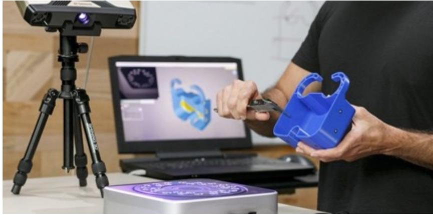
*Ilustración 12 Ejemplo de aplicación de la Ingeniería Inversa (Fuente: Sicnova).*
