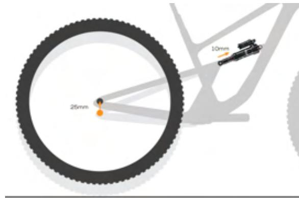
*Ilustración 27 Leverage Ratio (Fuente: Vorsprung suspension).*
