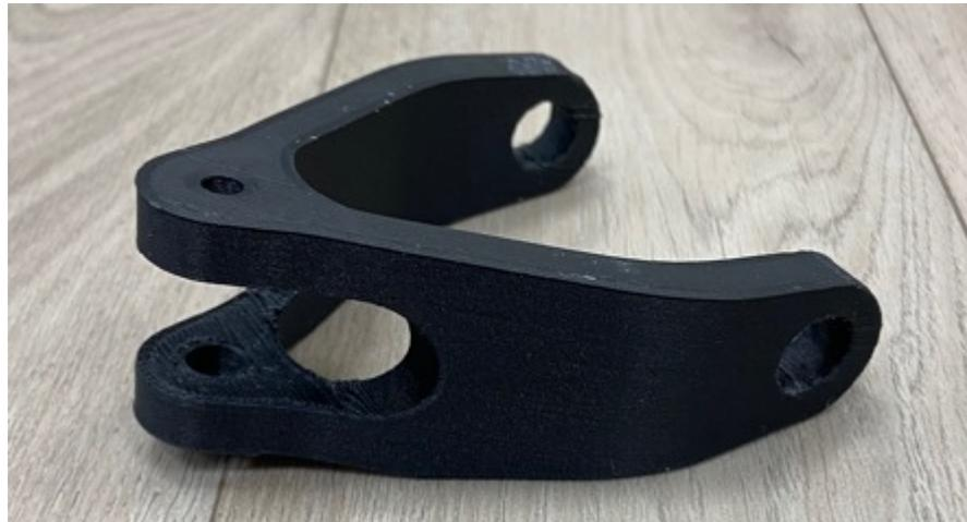
*Ilustración 124 Resultados de impresión de la bieleta en bruto en FDM, por la Markforged X7 (Fuente: Elaboración propia).*
