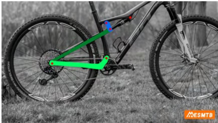
*Ilustración 32 Sistema Split Pivot, con punto de giro en rueda trasera (Fuente:ESMTB ).*
