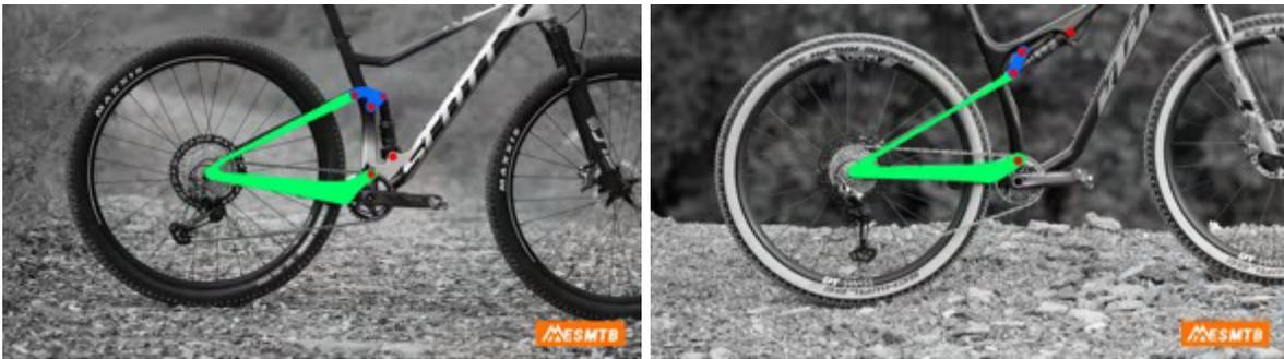
*Ilustración 30 Sistema Monopivote (Fuente: ESMTB).*
