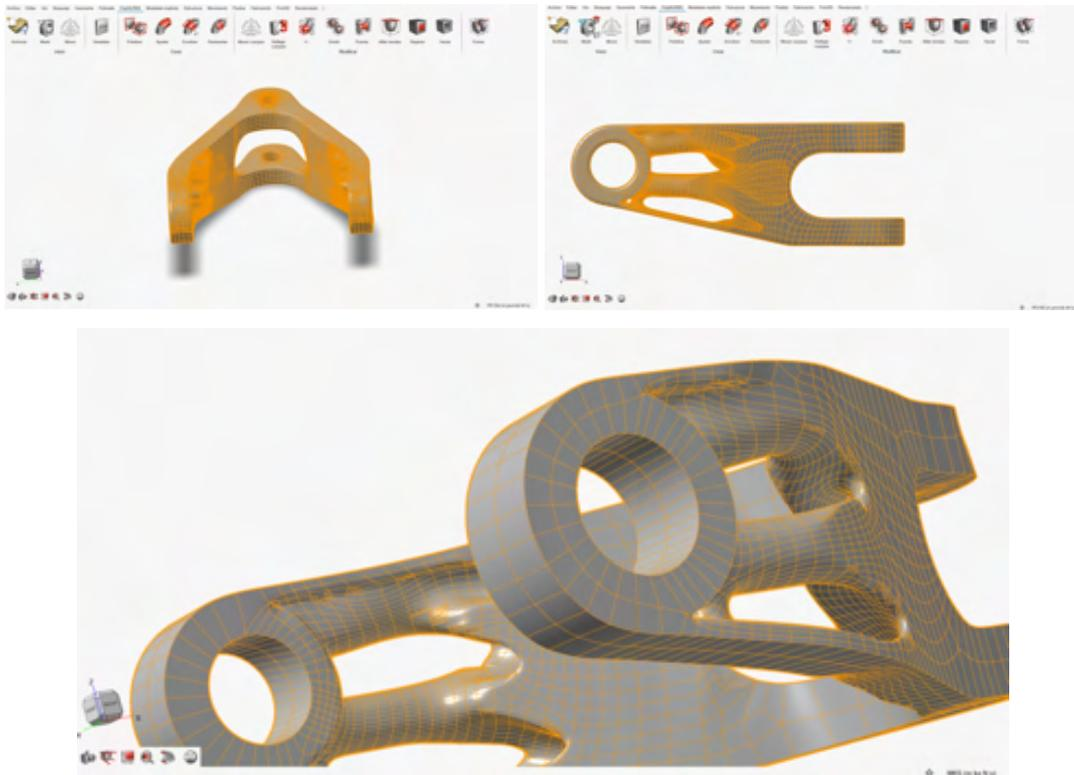
*Ilustración 108 Resultados del suavizado del prototipo N°2 en Altair Inspire (Fuente: Elaboración propia).*
