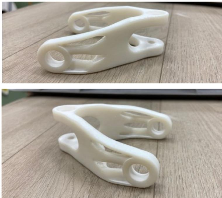
*Ilustración 139 Resultados impresión Prototipo N°2 tras el postprocesado en SLA. (Fuente: Elaboración propia).*
