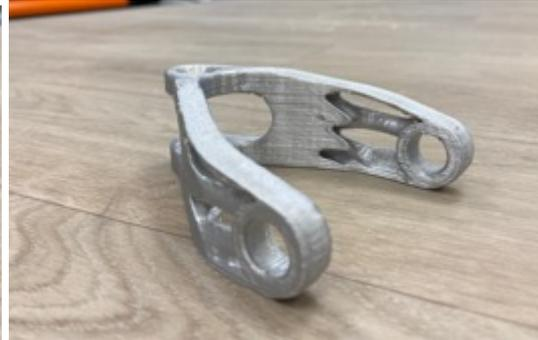
*Ilustración 128 Resultados impresión Prototipo N°2 tras el postprocesado (Fuente: Elaboración propia).*
