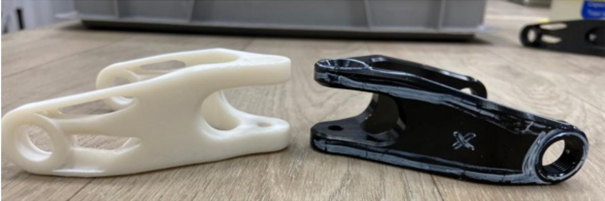
*Ilustración 140 Comparativa pieza impresa en SLA con el modelo original (Fuente: Elaboración propia).*
