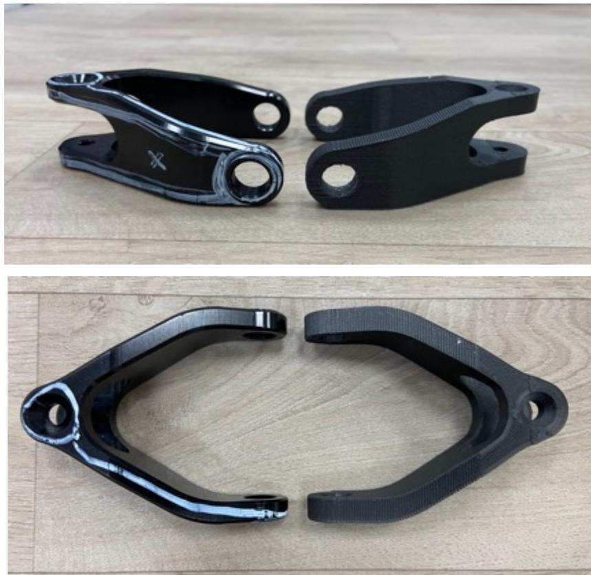
*Ilustración 125 Comparativa bieleta original con el modelo impreso (Fuente: Elaboración propia).*
