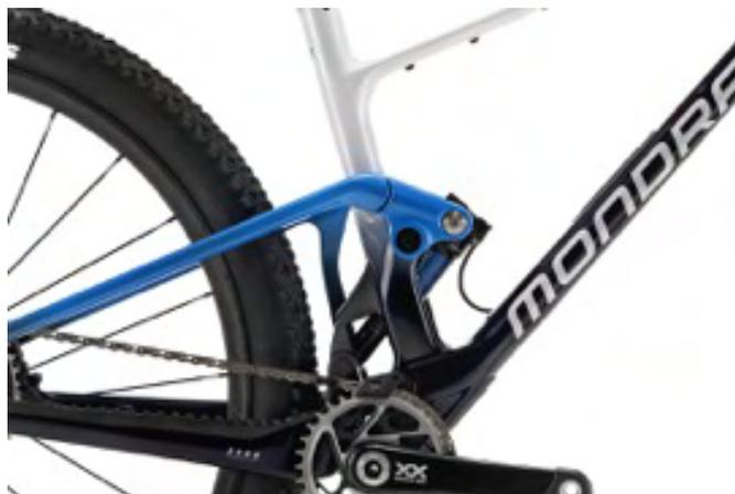
*Ilustración 34 Sistema amortiguación flotante (Fuente: MTB pro ).*
