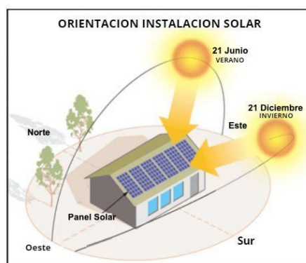
Figura 30: Dirección del sol en verano e invierno y su incidencia sobre los paneles solares.
