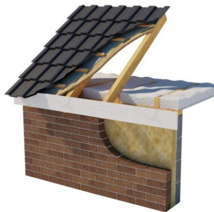
Figura 20: Ejemplo de aislamiento bajo cubierta
