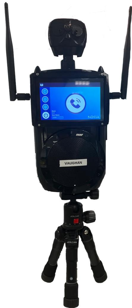
Figura 3.7. Sistema de telepresencia inmersiva Búho
