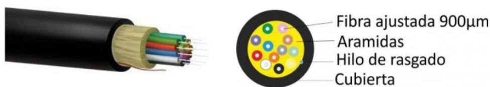
Figura 22: Estructura del cable de fibra óptica multimodo [12]
