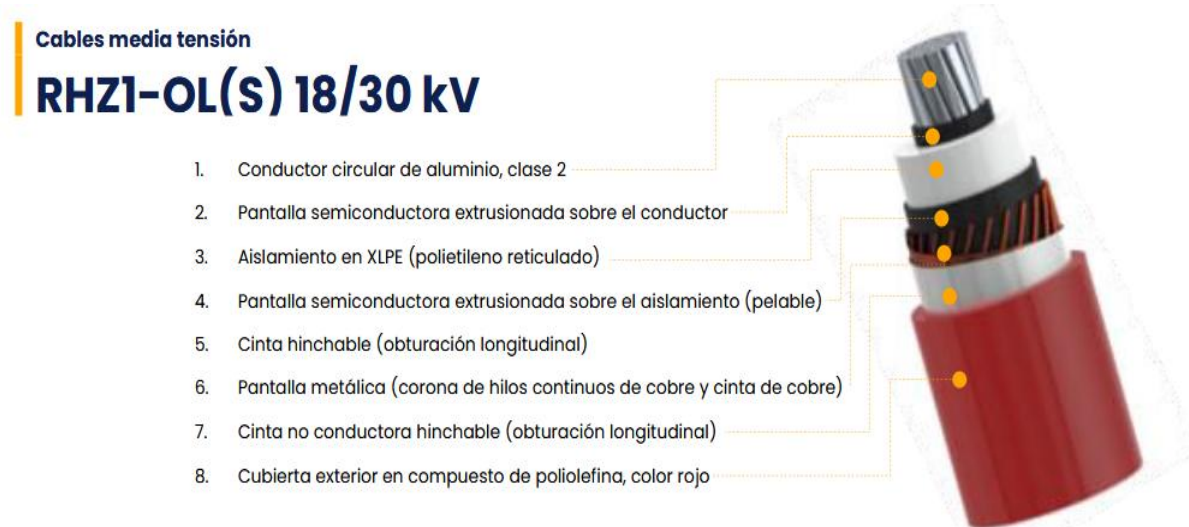
Figura 21: Capas del conductor de potencia de MT [11]
