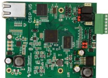
Figura 58: Ejemplo de una tarjeta PCB [46]
