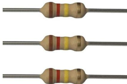
Figura 59: Resistencia 120 K $\Omega$
