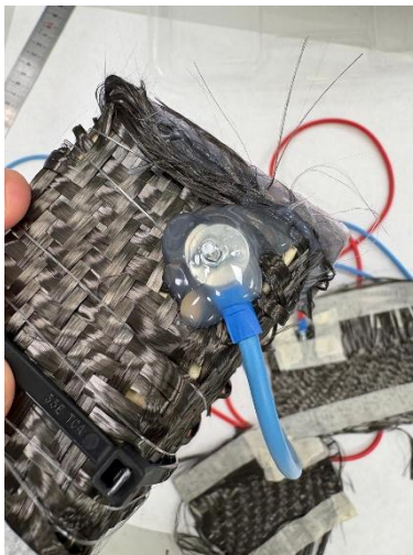
Figura 18 Conexión cátodo exterior
