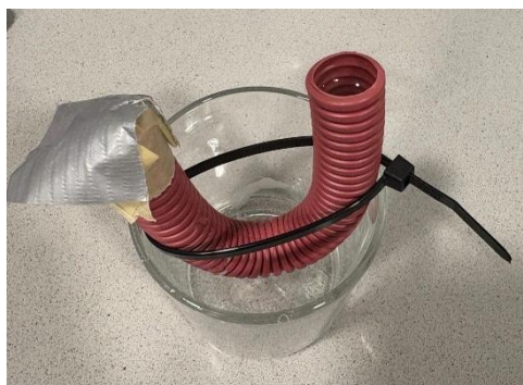
Figura 25 Puente salino utilizado en el ensayo
