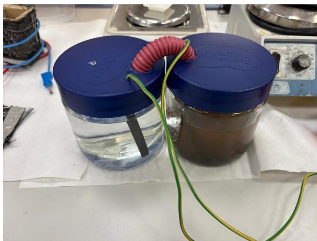
Figura 15 MFC de doble cámara de los ensayos
