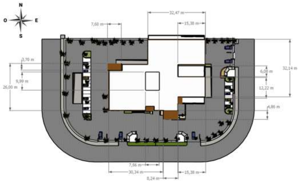
Figura 15. Planta del hospital acotada (AdityaS, 2018)
