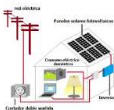
Ilustración 26: Conexión mediante inversor [15]
