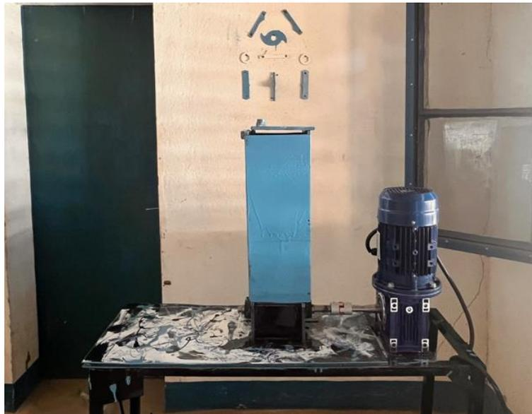
*Figura 46. Trituradora con el motor eléctrico ya instalado.*
