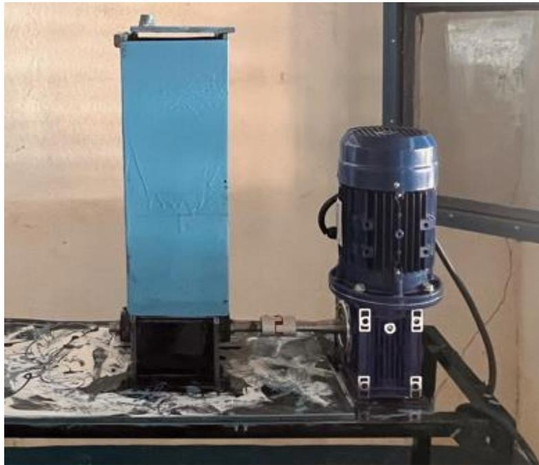
*Figura 23. Versión final de la trituradora con el motor eléctrico acoplado con el eje Old Man.*
