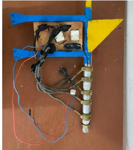
*Figura 38. Disposición final de las resistencias en la inyectora.*
