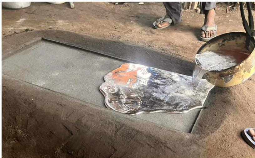
*Figura 48. Vertido del material en el molde de arena al descubierto.*
