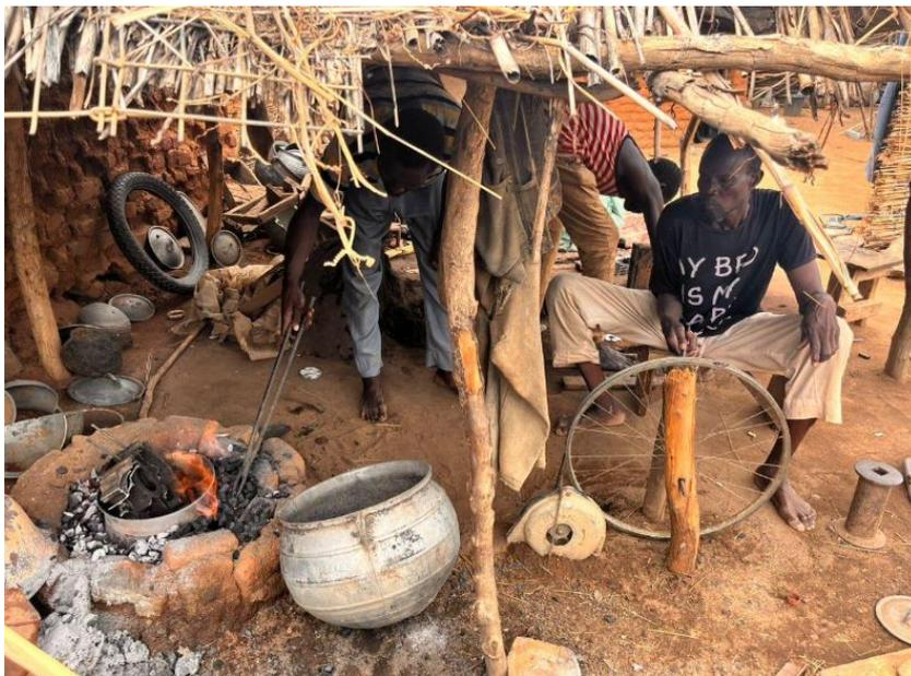
*Figura 47. Fundidor en su taller dándole vueltas a la manivela para avivar el fuego.*
