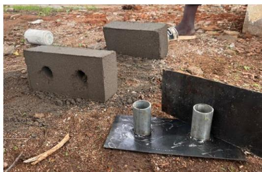
*Figura 61. Ladrillos finalizados tras desmoldar.*
