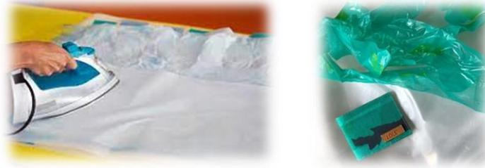
*Figura 60. Ejemplos de producción de tejidos plástico por planchado.*
