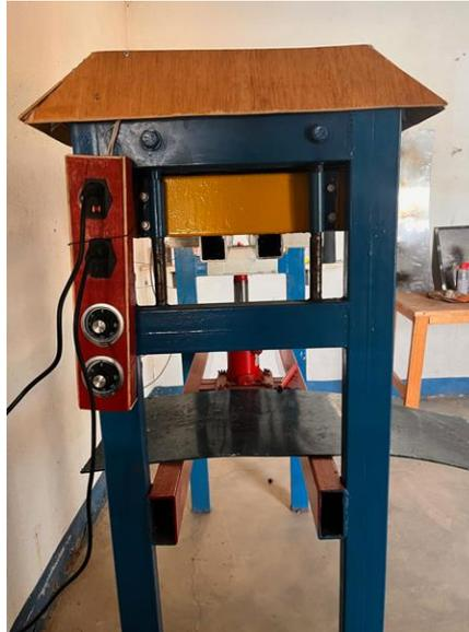
*Figura 51. Prensa con la caja de electrónica ya instalada.*
