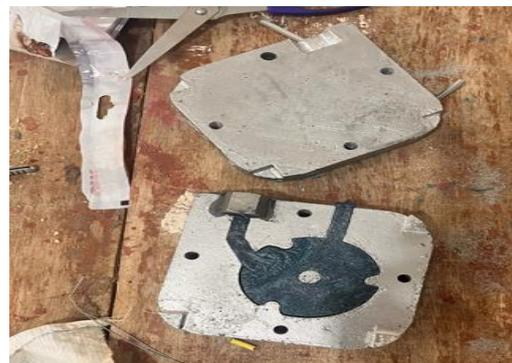
*Figura 16. Plástico triturado colocado en la prensa de calor para ser procesado y desmolde de pieza producida en la inyectora*
