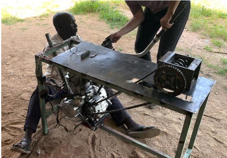
*Figura 22. Instalación del motor de combustión en la estructura de la trituradora.*
