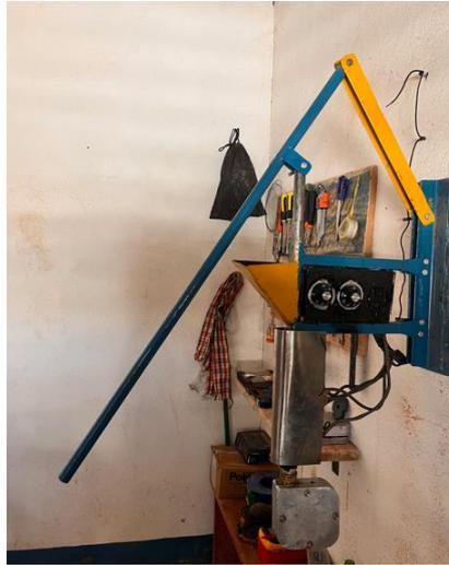
*Figura 55. Inyectora instalada en el taller con instalación eléctrica acabada .*
