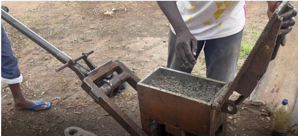
*Figura 62. Proceso de prensado de los ladrillos.*
