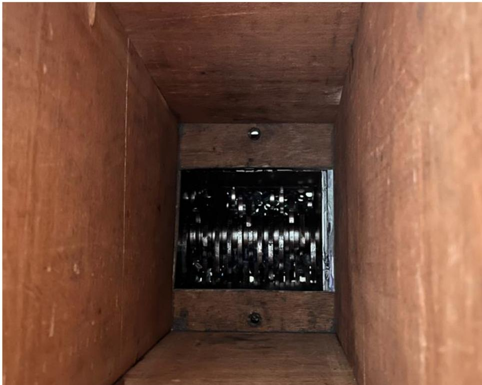
*Figura 42. Imagen final de la caja trituradora vista desde arriba a través del cono de alimentación.*
