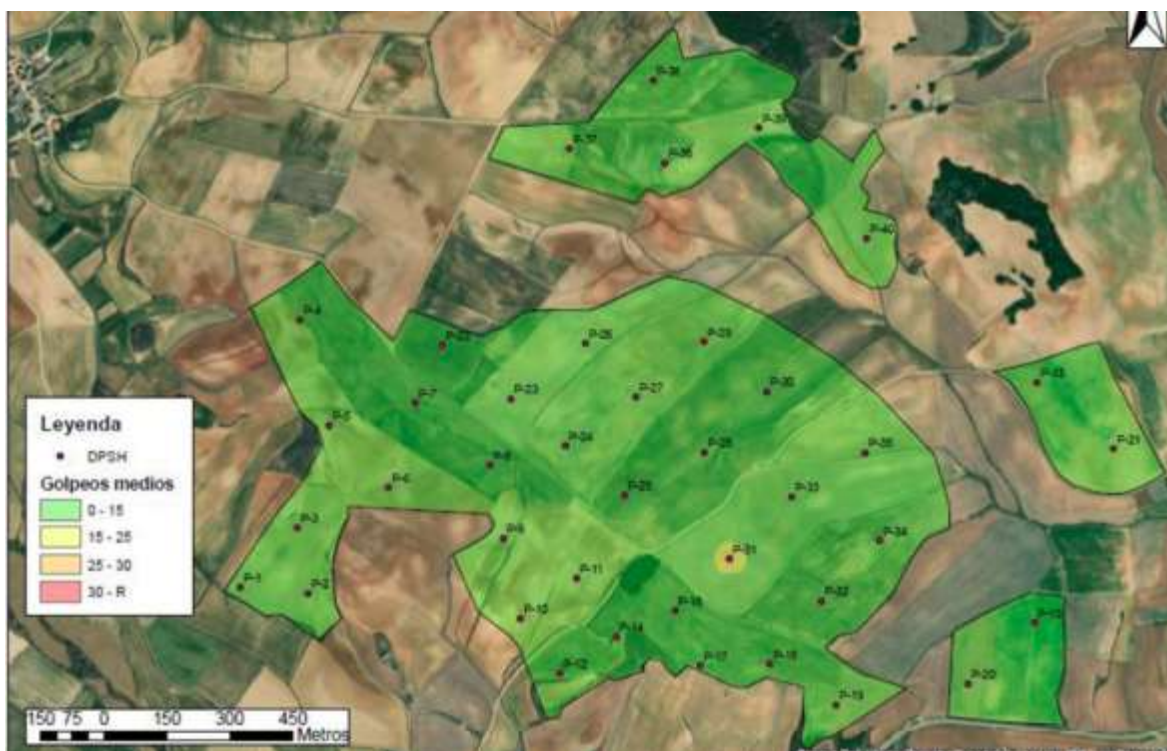
Ilustración 16. Zonificación del terreno a efectos de la hinca de los perfiles.[1]
