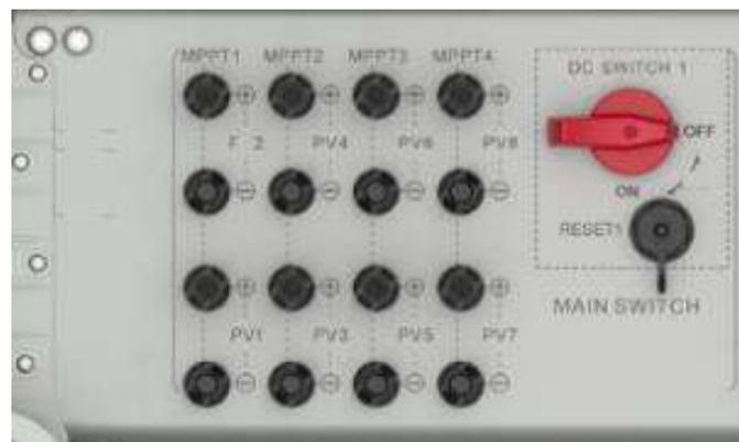
*Figura 6: Entradas organizadas por MTP al inversor HUAWEI SUN2000-100KTL-M3*
