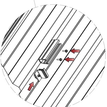
**PASO 7:** Poner las fijaciones 61H sobre la greca de la chapa con dos tornillos autorroscantes cada fijación. Ir colocando los módulos y fijarlos con los presores S10.3 en los laterales y los presores S11.3 en las zonas centrales. La distancia entre los puntos de anclaje del módulo dependerá del tamaño del mismo. Consultar la ficha técnica del módulo a instalar.
