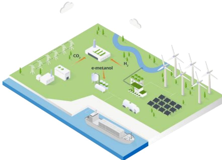
Imagen 2. Sistema de producción de Metanol Verde (Fuente: Iberdrola)
