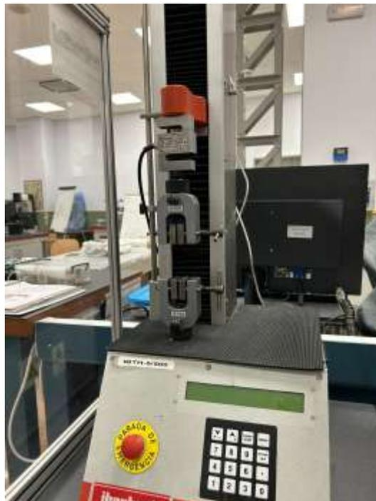
*Ilustración 5. Máquina ensayos de tracción (IBTH 500 Ibertest)*
