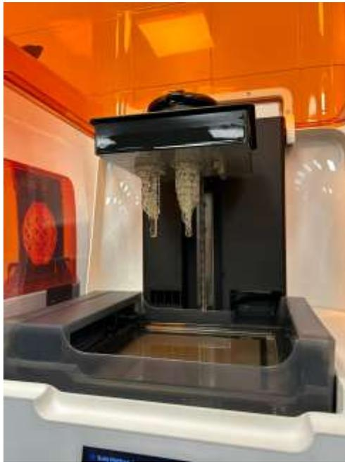
*Ilustración 9. Probetas recién impresas colocadas en el interior de la máquina 3D*
