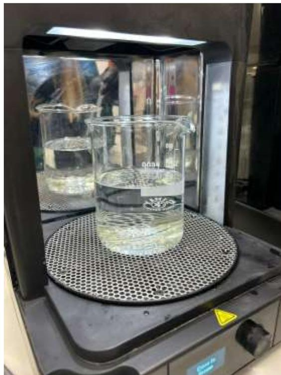
*Ilustración 11. Cura de las probetas*
