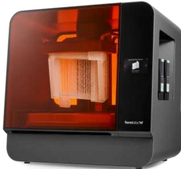
*Ilustración 1. Impresora mediante estereolitografía (SLA) [5]*
