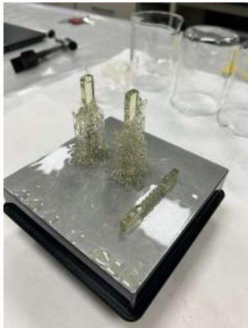
*Ilustración 10. Probetas con soporte*
