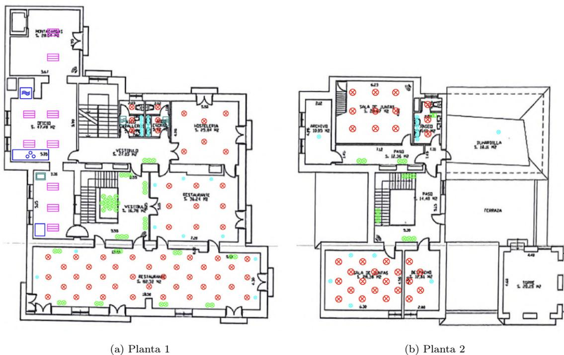
Figura 3.2: Planos puntos de consumo eléctrico Planta 1 y 2 (Fuente: Elaboración Propia, 2025)
