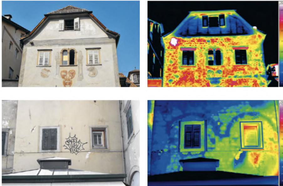
Figura 2.10: Pruebas termográficas Waaghaus (Fuente: Roberti et al. 2017)
