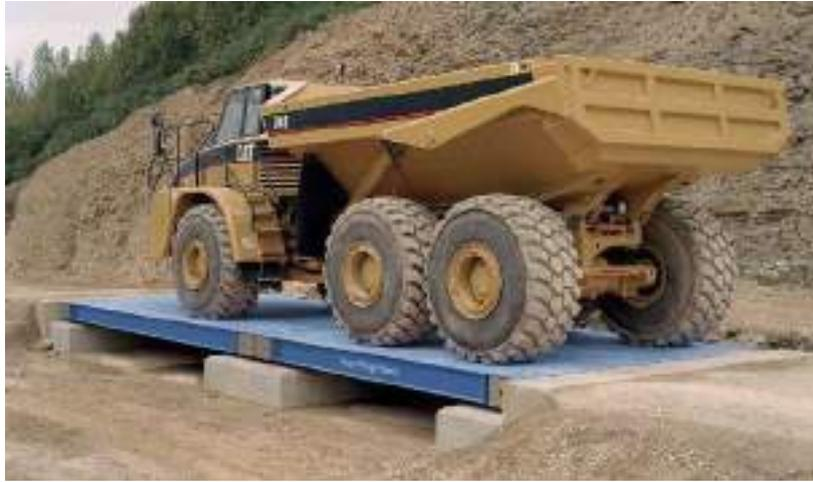
*Figura 14. Báscula para camiones (Avery Weigh Tronix)*
