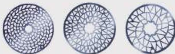
Vogelsang utiliza un software propio para calcular la geometría óptima de la pantalla de corte y obtener así el tamaño de partícula deseado. De esta manera, seleccionamos la mejor geometría para operar de manera suave con un desgaste mínimo. Las pantallas de corte son reversibles y están fabricadas en acero especial de alta resistencia al desgaste.
