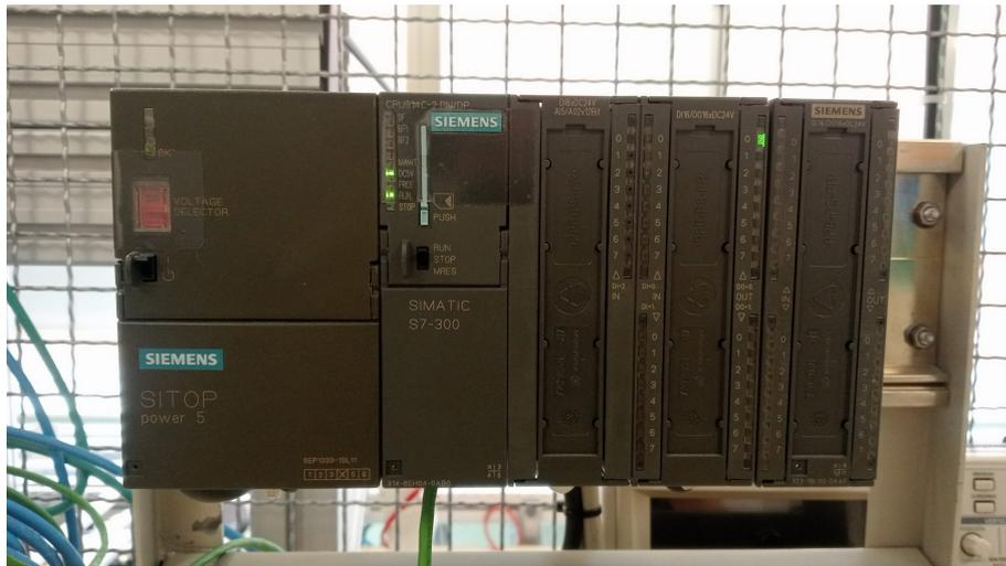
Figura 3.1: Equipo Siemens Simatic S7-300
