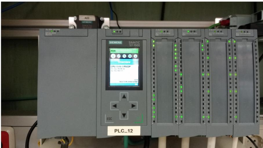
Figura 2.3: Equipo Siemens Simatic S7-1500
