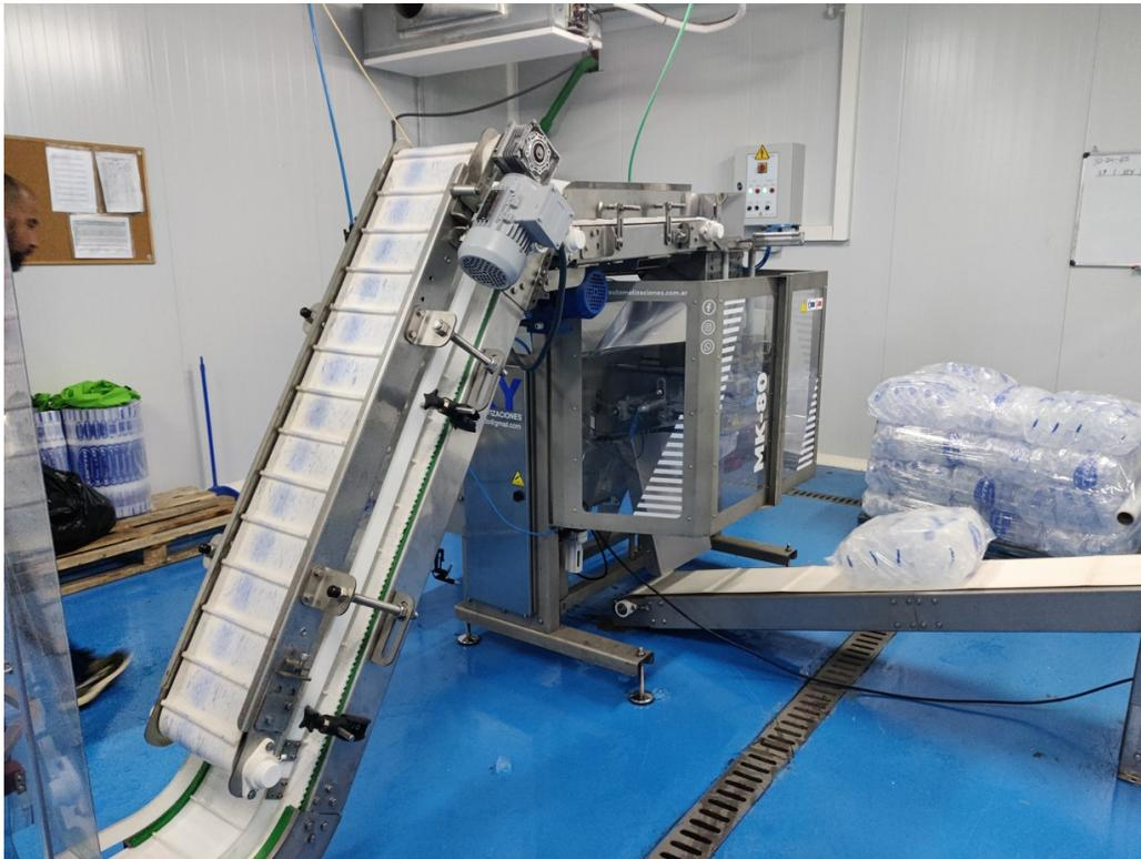
Ilustración 2.14: Foto de la Empaquetadora
