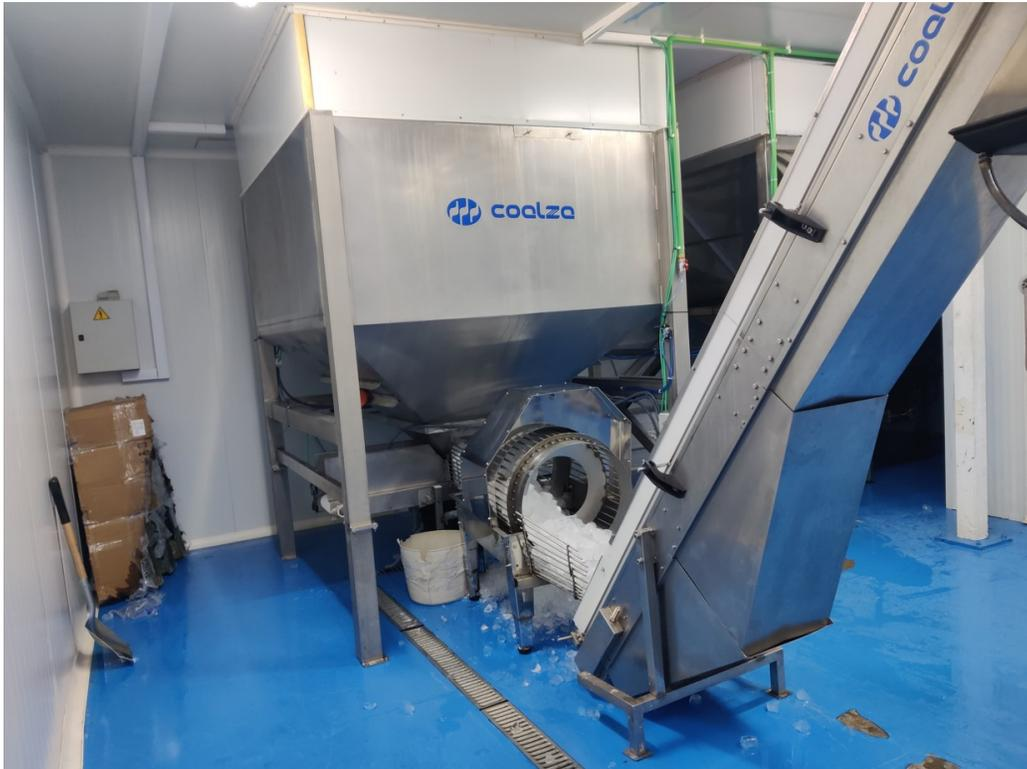
Ilustración 2.12: Foto de las Tolvas y la Cinta Transportadora del Área de Envasado
