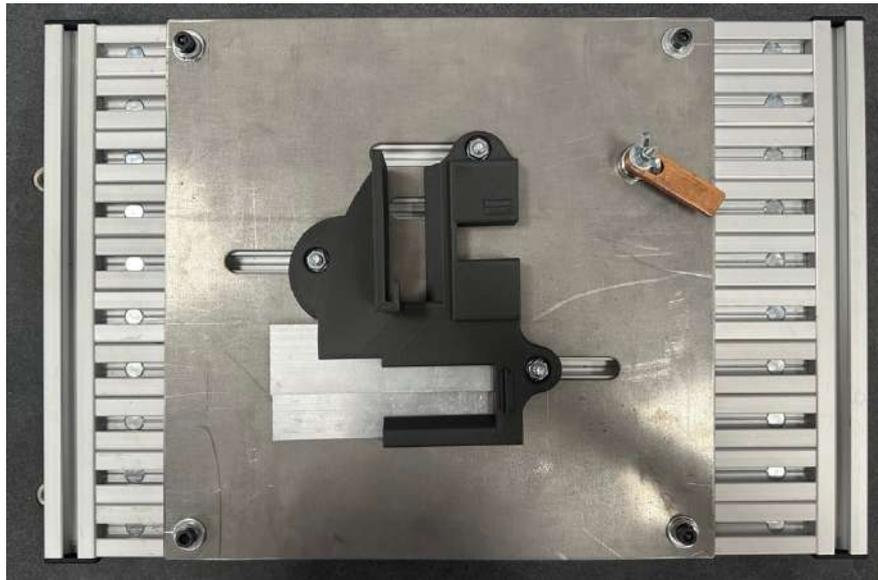
*Figura 1: Arquitectura de la herramienta: utillaje de sujeción para 3 posiciones de soldadura.
