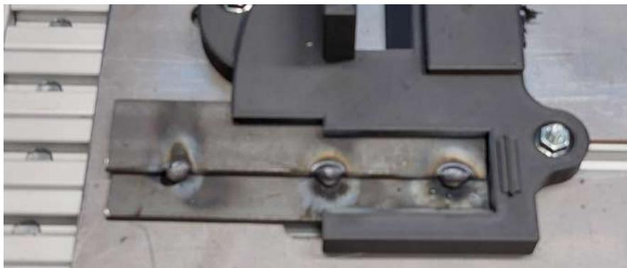
*Figura 2: Resultado punteado en posición de solape. Fuente: Elaboración propia.*
