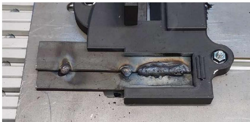
*Figura 63: Resultado soldadura en solape.
