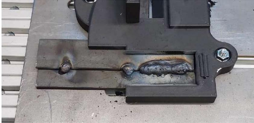
*Figura 3: Resultado soldadura continua en posición de solape. Fuente: Elaboración propia.*
