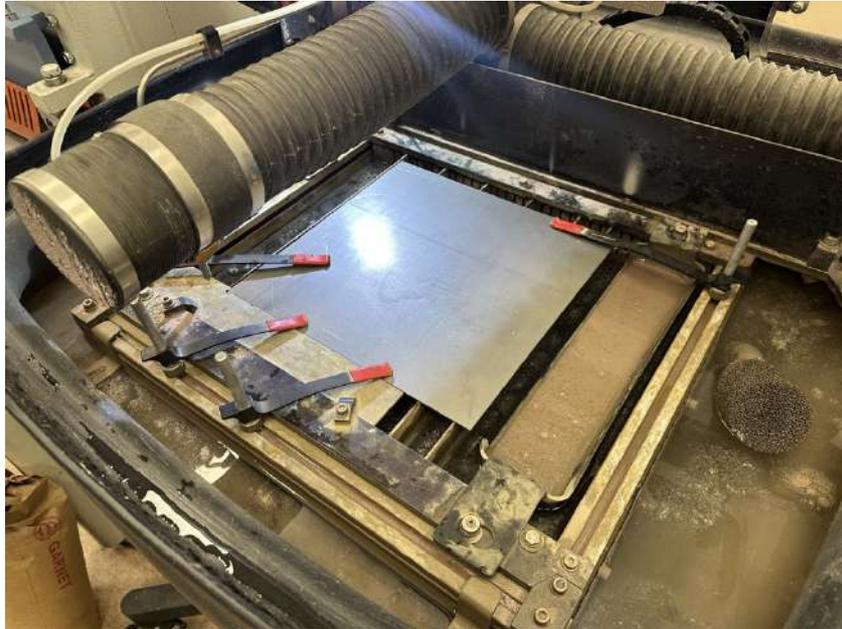
*Figura 51: Proceso de corte por chorro de agua.
