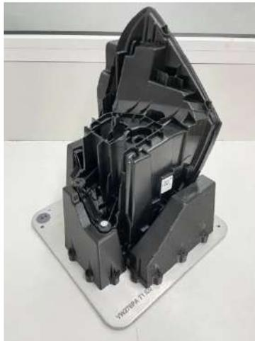
Figura 20: Utillaje de montaje de iMES3D.
