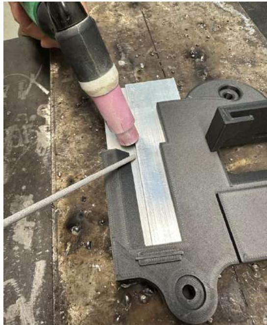
Figura 45: Espacio insuficiente para soldadura en solape.
