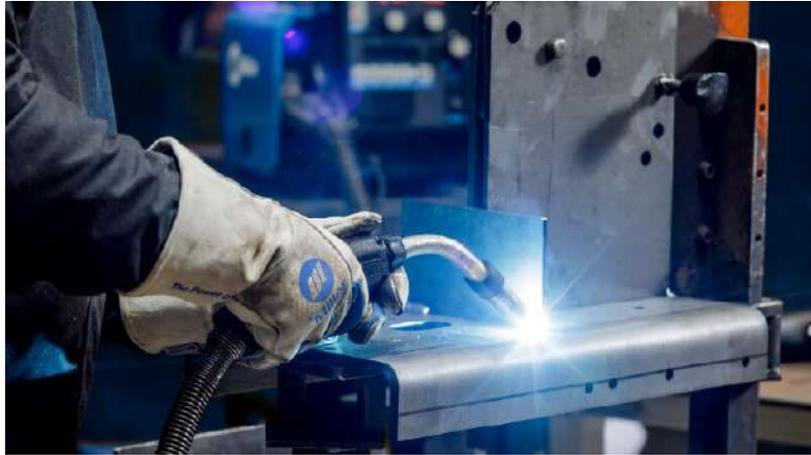
*Figura 37: Soldadura MIG.*
