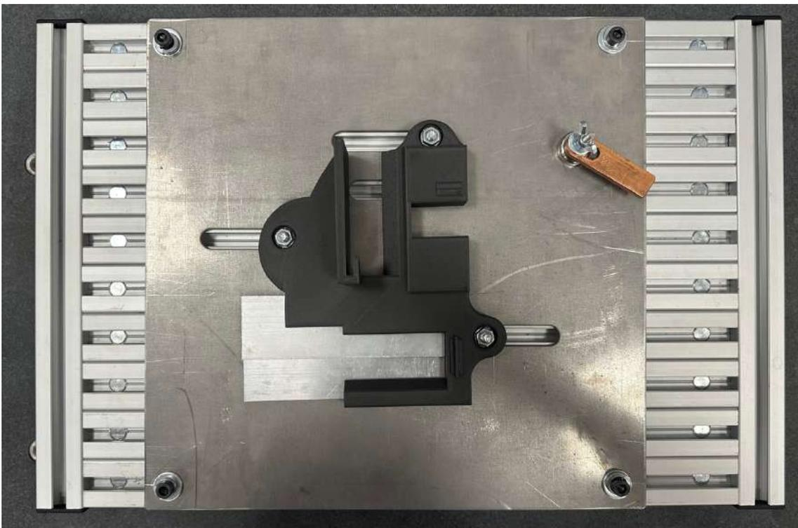
*Figura 56: Montaje final para soldadura en solape.
