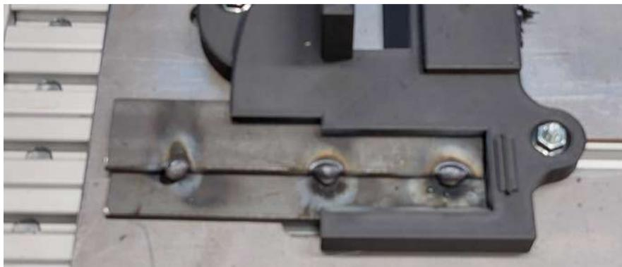
*Figura 60: Resultado punteo en solape.
