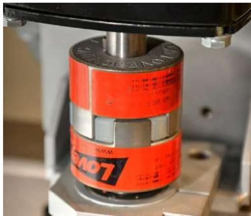
*Figura 31: Acoplamiento de araña impreso en 3D para una máquina de AM Tool.*
