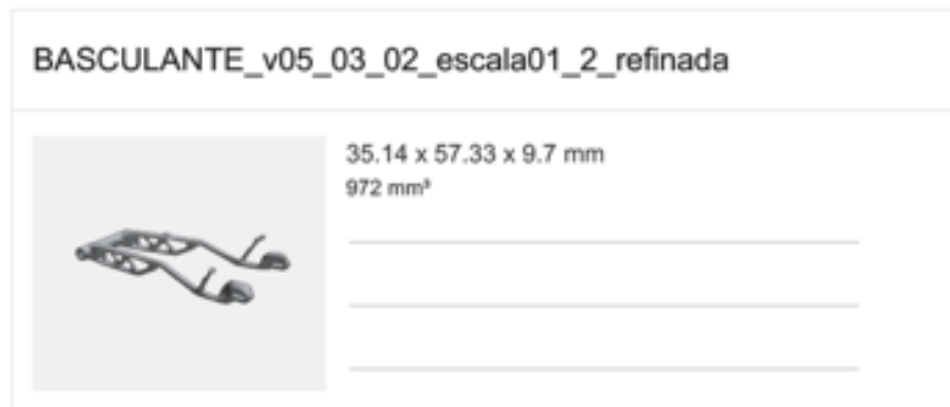
Ilustración 84 Cálculo del volumen de material de impresión
