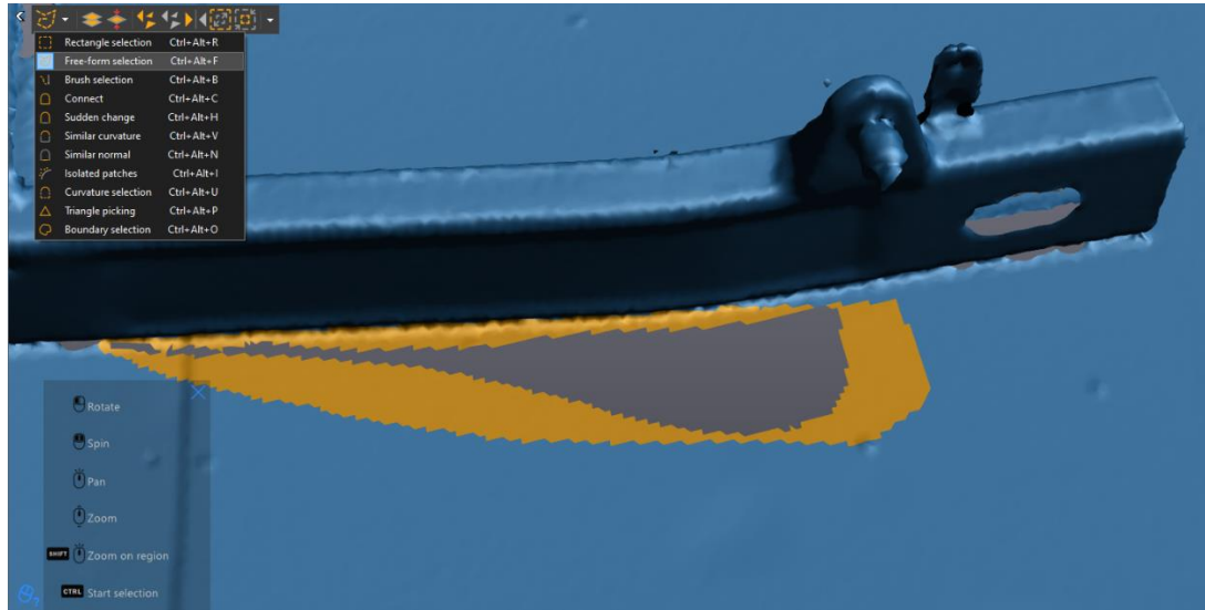
Ilustración 23 Uso de la herramienta "Free form selection"
