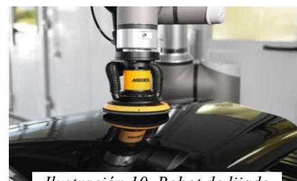
*Ilustración 10. Robot de lijado*
