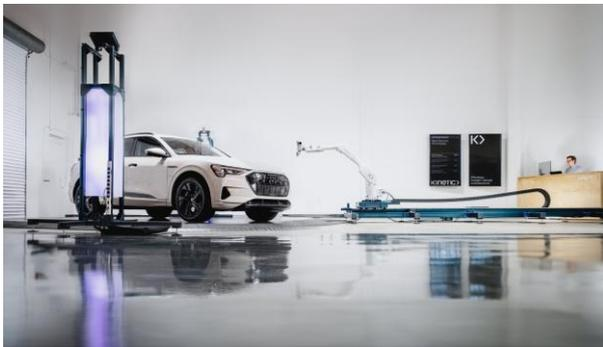
*Ilustración 6. Sistema automatizado de calibración de ADAS de Kinetic Automation*
