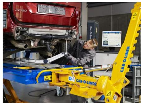
*Ilustración 9. Bancada Car-O-Liner con medición laser 3D*
