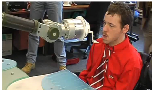
Figura 1. Robot ASIBOT desarrollado por el RoboticsLab de la Universidad Carlos III de Madrid para la asistencia a personas con movilidad reducida
