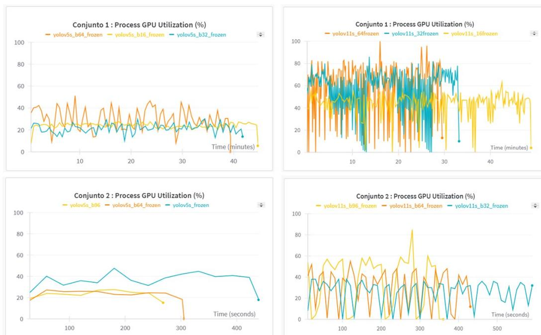
Figura 4.13: Resultados de uso de la GPU para el modelo YOLOv5s y YOLO11s utilizando diferente tamaño de batch.
