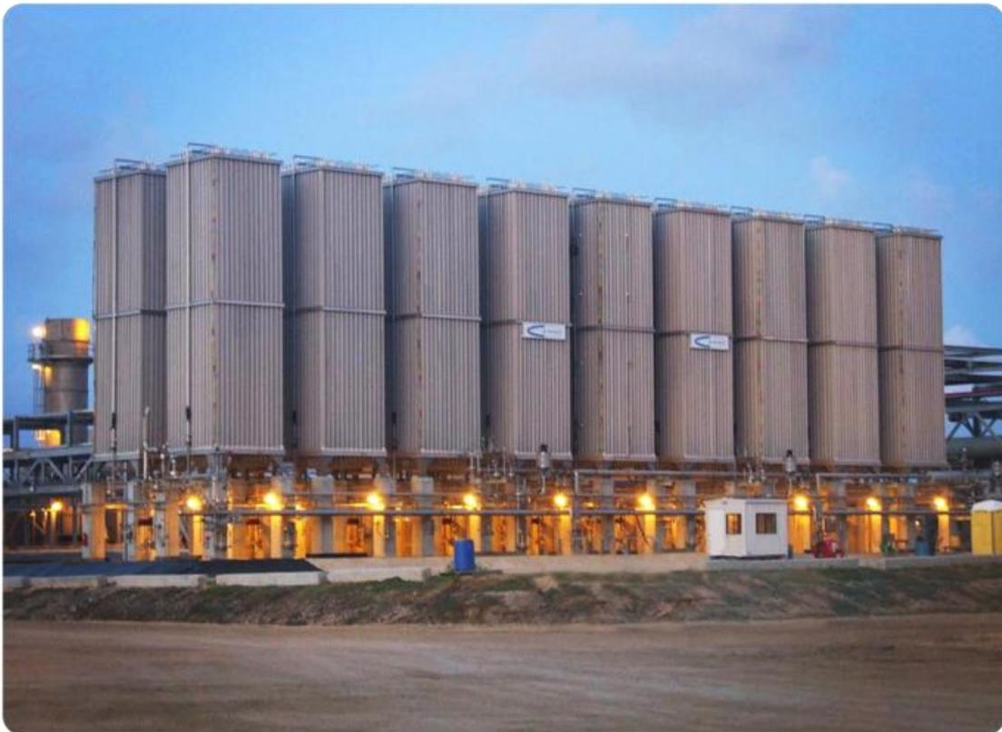
*Figura 8. Vaporizador de aire atmosférico*
