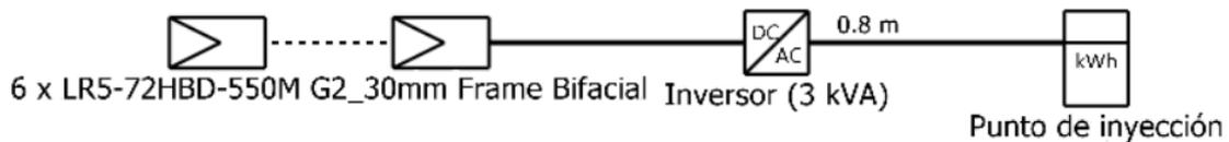
Figura 35 Diagrama Unifilar Caso 4.
