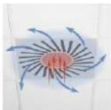
Impulsión rotacional y retorno incluido
