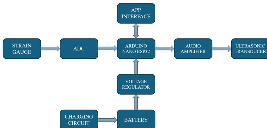
Image 1 - Diagrama de bloques del sistema del collar
