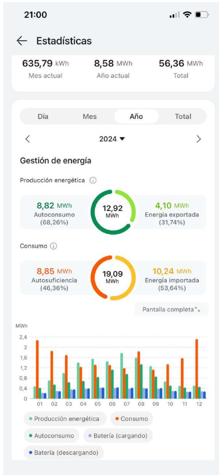
Figura 7.36: Consumo y producción fotovoltaica registrados por la aplicación FusionSolar durante el año 2024. Fuente: aplicación FusionSolar.
