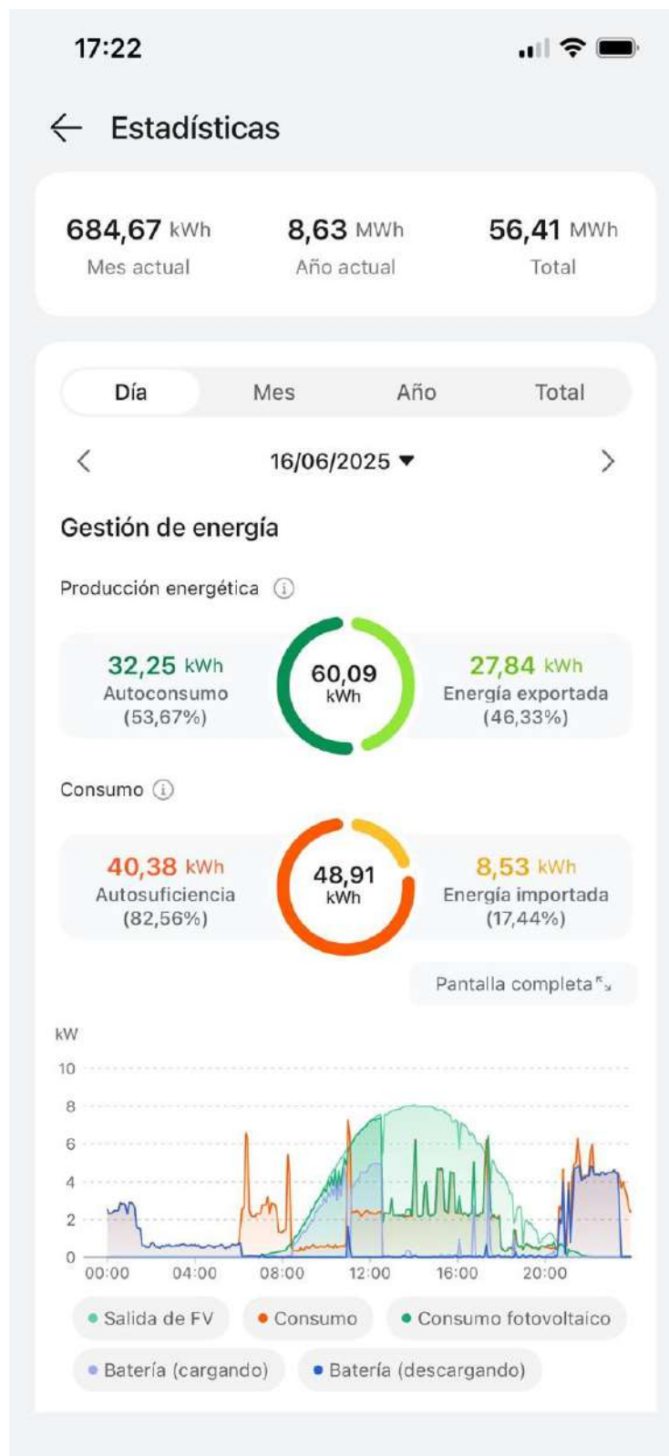
Figura 7.34: Producción y consumo energético registrados por la aplicación FusionSolar en un día de verano (16/06/2025). Fuente: aplicación FusionSolar.
