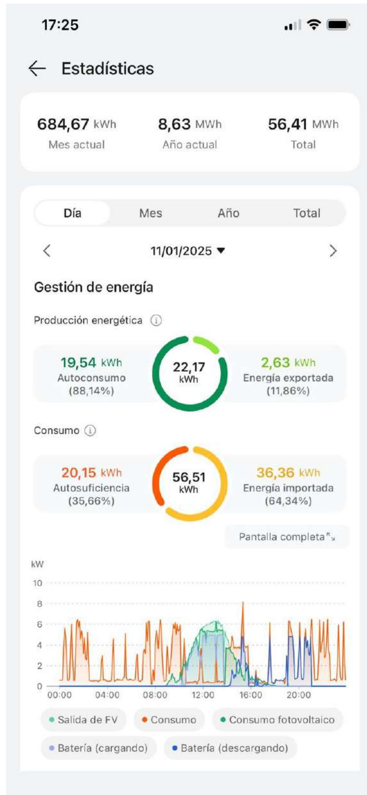
Figura 7.35: Producción y consumo energético registrados por la aplicación FusionSolar en un día de invierno (11/01/2025). Fuente: aplicación FusionSolar.
