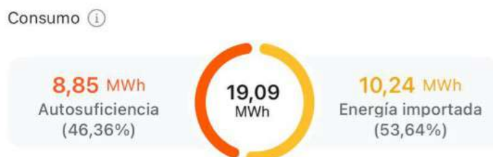
Figura 7.25: Consumo eléctrico anual de la vivienda. Fuente: App: FusionSolar
