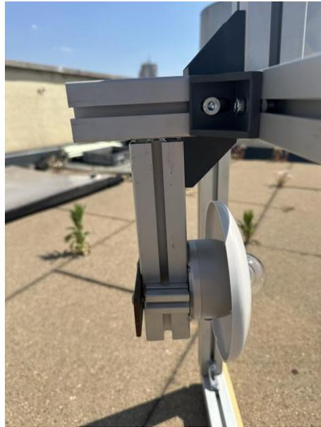
*Figura 15. Estructura de sujeción del piranómetro*
