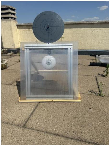
*Ilustración 2. Vista frontal de la estructura con doble panel con los canales del más externo en vertical*
