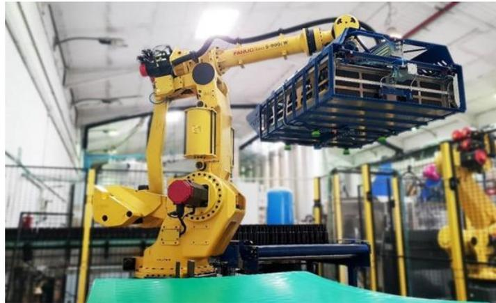
*Ilustración 20. Cobot despaletizador*
