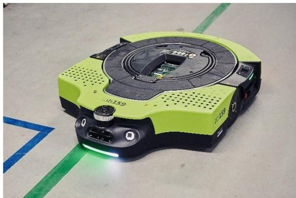
*Ilustración 27. Robot Proteus de Amazon Robotics*
