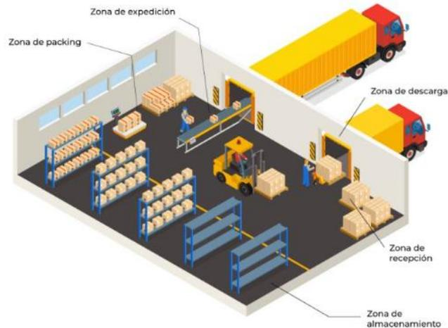
*Ilustración 10. Ejemplo gráfico del layout de un almacén*
